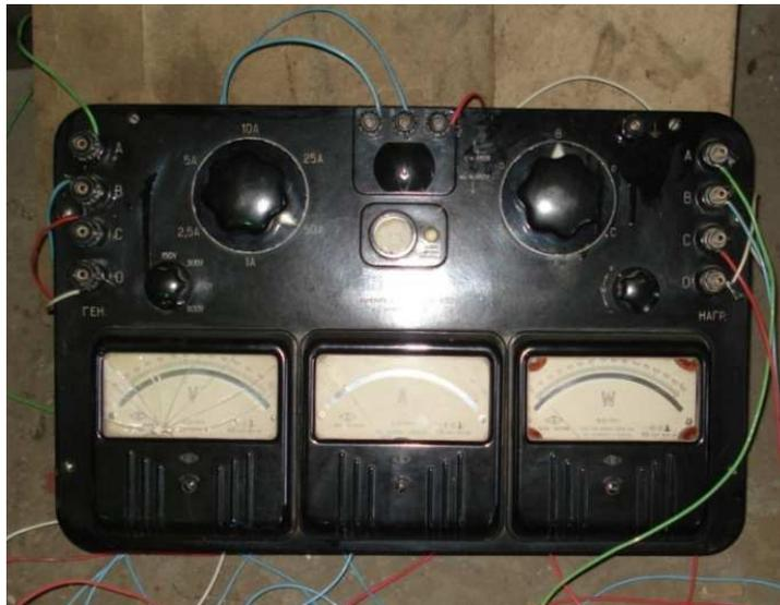
Рисунок 4.9 – Контрольно-измерительный щиток К-50
