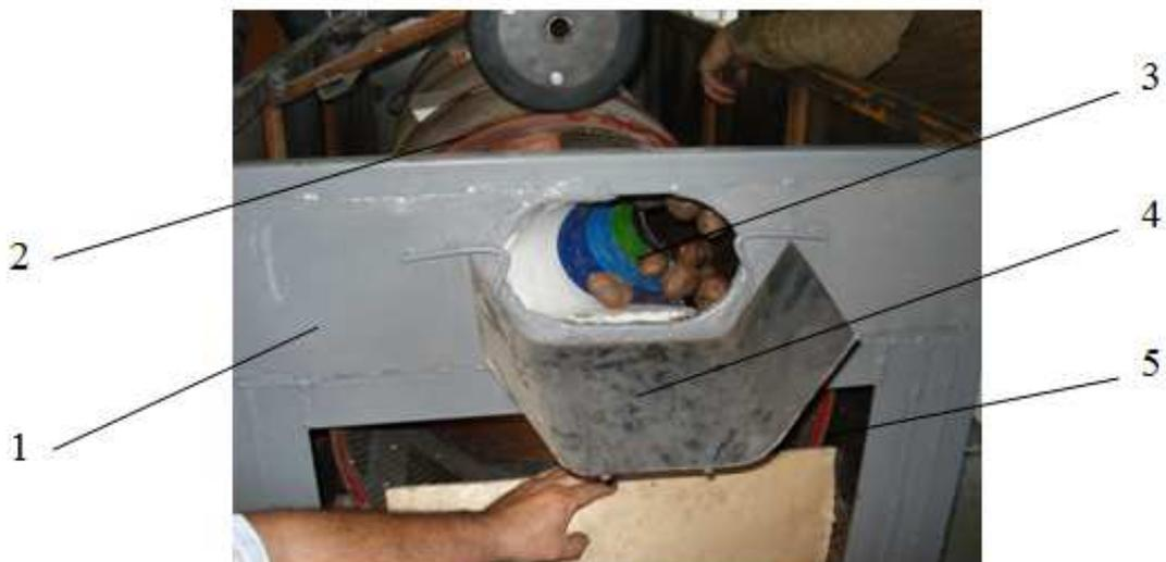
Рисунок 4.1 – Фрагмент лабораторно-производственной установки для мойки корнеклубнеплодов
