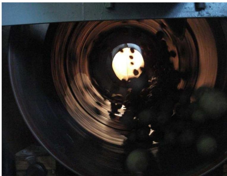
Рисунок 4.11 – Поведение корнеклубнеплодов при частоте вращения барабана  $\rightarrow n_{кр}$
