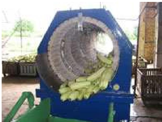
Рисунок 1.10 – Корнеклубнеовощемойка непрерывного действия
