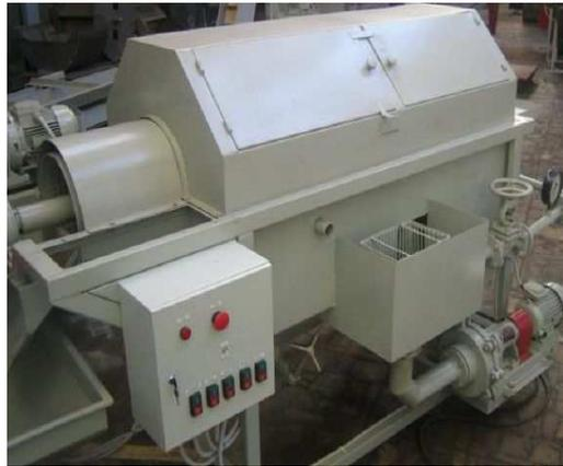
Рисунок 1.11 – Машина моечная барабанного типа с камнеотборником
