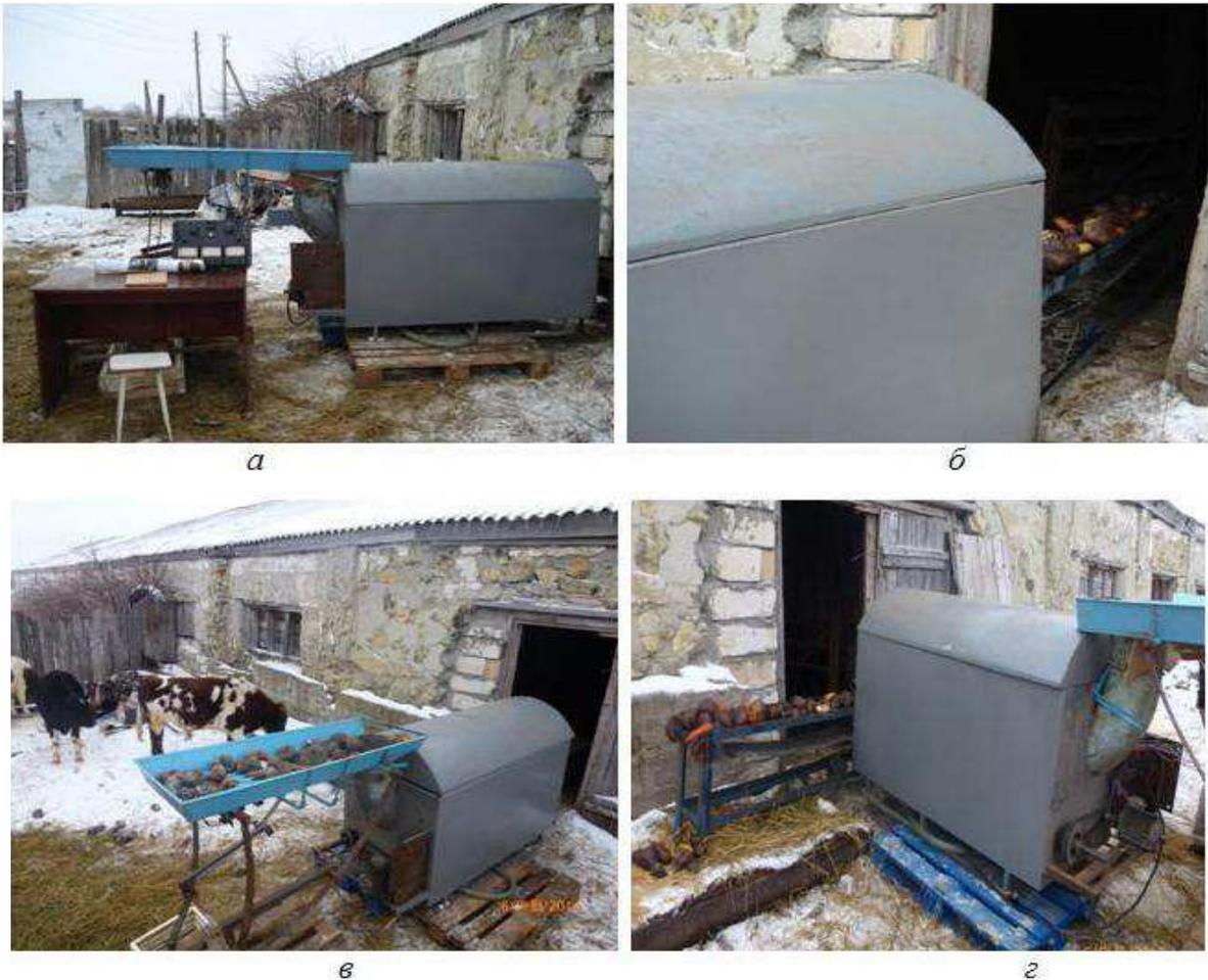
Рисунок 4.8 –Испытания барабанной гидротурбинной корнеклубнемойки *а* – главный вид лабораторной установки; *б* – вид на линию подачи корнеклубнеплодов в кормушки коровника; *в* – вид на загрузочный транспортер отделитель механических примесей; *г* – вид на транспортер подачи корнеклубнеплодов в кормушку на выгульной площадке для КРС
