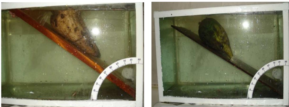
Рисунок 2.8 – Начало движения корнеплода в воде вдоль продольной оси, головкой вверх
