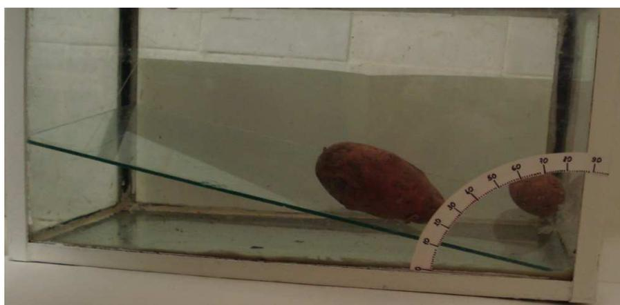
Рисунок 2.10 – К определению угла трения клубнеплода на стекле небьющемся
