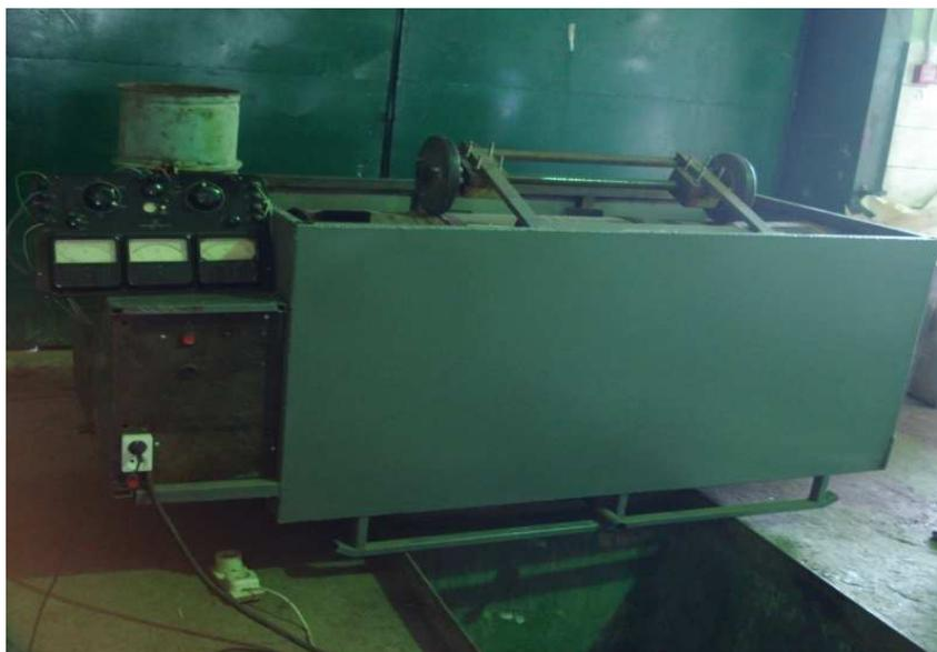
Рисунок 5.1 – Опытный образец гидротурбинной корнеклубнемойки
