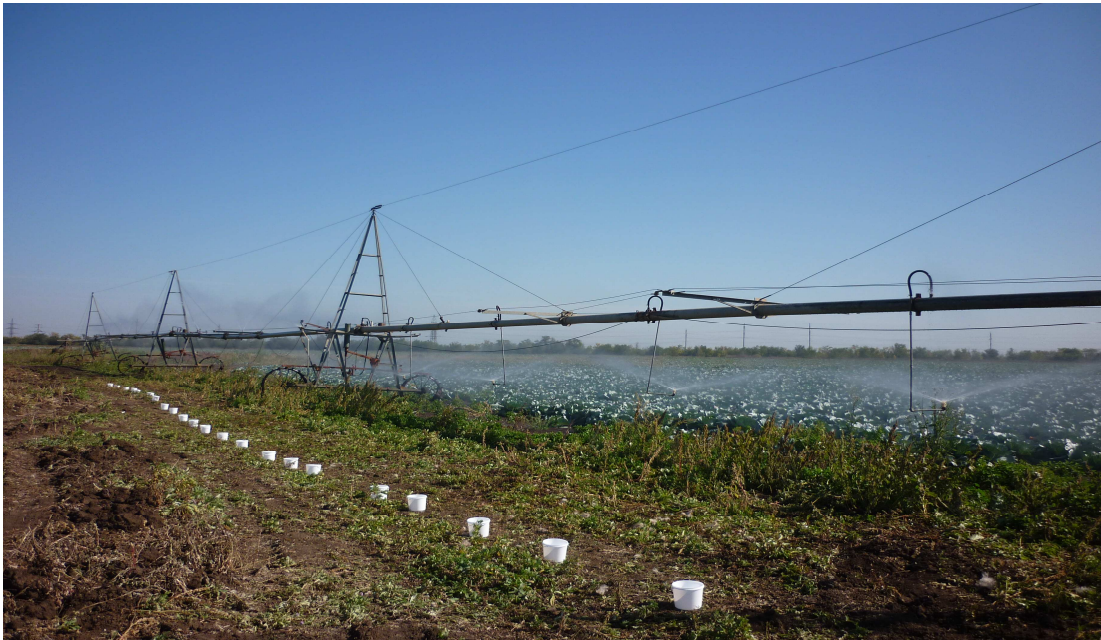
Рисунок 3.9 – Расстановка дождемеров вдоль водопроводящего трубопровода дождевальной машины «Фрегат»
