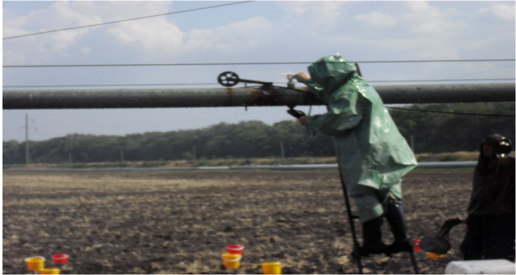
Рисунок 3.3 – Замер динамического напора при помощи трубки Пито на выходе струи из дефлекторной насадки.
