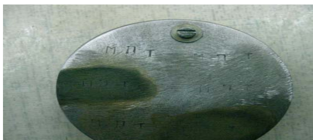
Рис. 5. Потемнение площадки в процессе восстановления маркировочных обозначений с использованием 1%-го раствора серной кислоты
