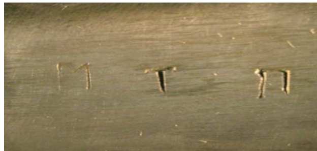
Рис. 3. Результат восстановления маркировочных обозначений с использованием электролита на основе 15%-го водного раствора бихромата калия
