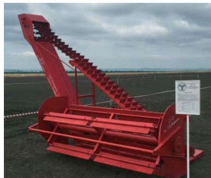
Рис. 3. Опытный образец погрузчика непрерывного действия для зерна
