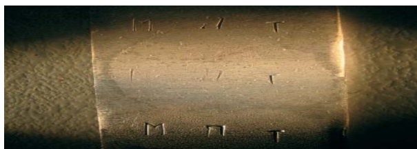
Рис. 7. Отсутствие растворения поверхности при проведении электролитического травления с использованием электролита следующего состава: 4%-й раствор азотной кислоты в ацетонгидриде – 30 мл; метиловый спирт – 10 мл; этиловый спирт – 10 мл
