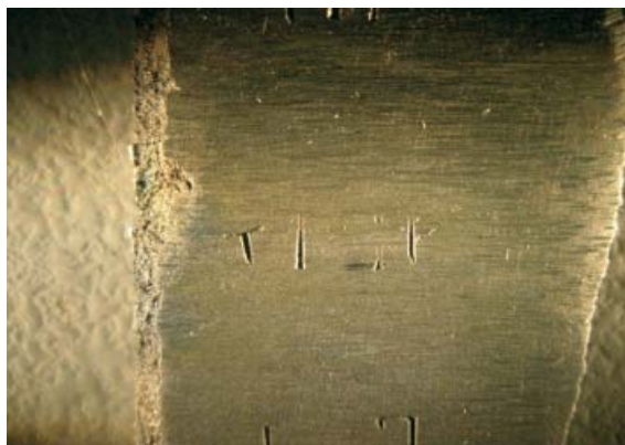
Рис. 1. Результат восстановления маркировочных обозначений с использованием электролита следующего состава: сернокислая медь – 1 г, желатин – 1 г, концентрированная серная кислота – 10 мл, вода дистиллированная – 500 мл
