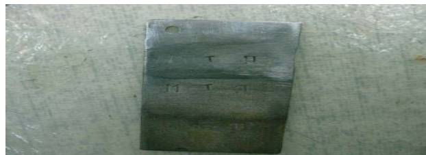
Рис. 6. Образование темного налета при проведении электролитического травления с использованием 30%-го водного раствора молибденовокислого аммония
