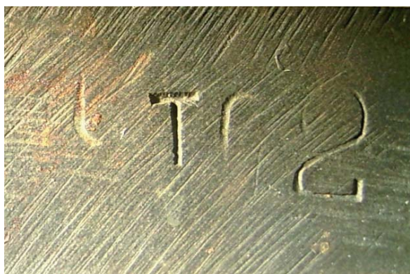
Рис. 2. Результат восстановления маркировочных обозначений с использованием электролита на основе 10%-го водного раствора персульфата аммония
