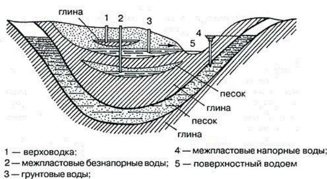
Рис. 2. Схема залегания грунтовых вод
