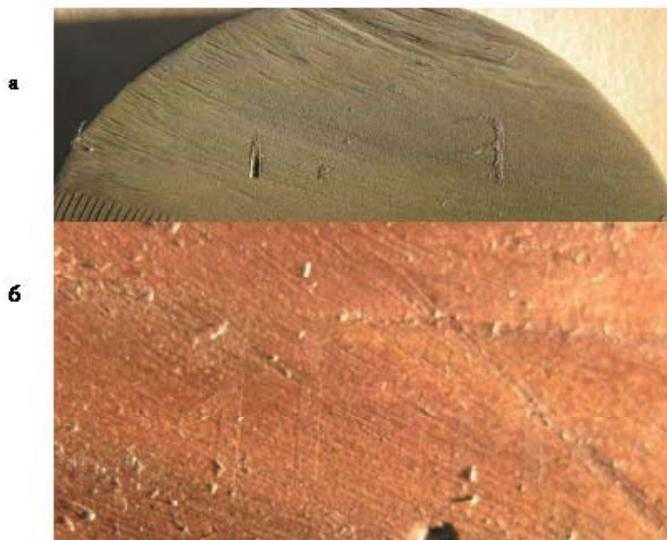
**Рис. 1. Восстановленные штрихи маркировочных обозначений, полученных лазерным гравированием: а) на алюминиевом сплаве Д1; б) на меди катодной**
