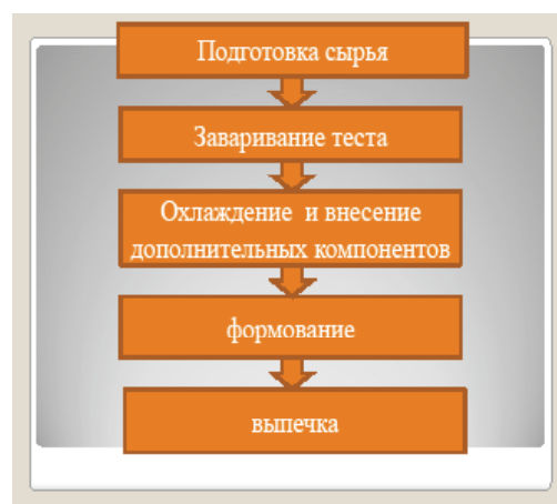
Рис. 2. Структурная технологическая схема производства полуфабриката заварных пирожных
