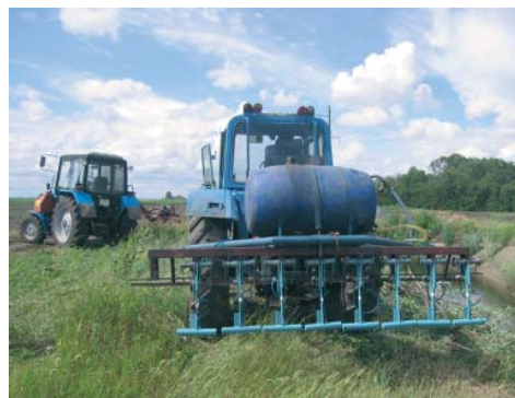
Рис. 2. Подборщик-собирающий ПС-2(СГАУ), оснащенный навесным устройством для локального унетения пней арборицидами
