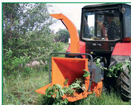
Переработка древесины в щепу навесной рубильной машиной с последующей ее транспортировкой грузовым автомобилем
