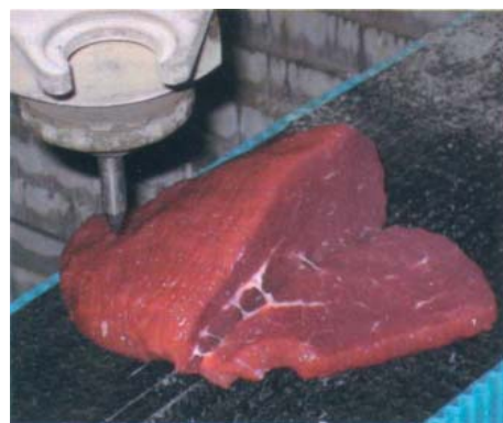
Рис. 1. Экспериментальная резка говядины струей воды
