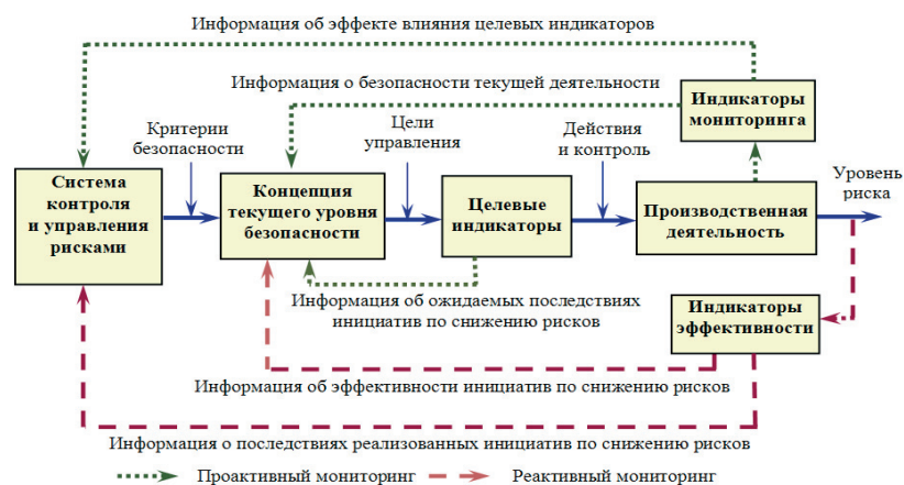
Рис. 4. Модель системы контроля и управления рисками (Risk Control Systems – RCS)
