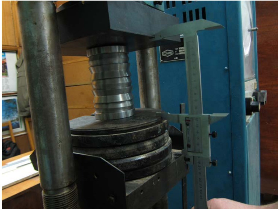
Рисунок 3.9 – Замер величины деформации кольцевой пружины
