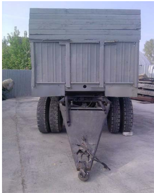
Рисунок 3.5 – Общий вид прицепа с пружинным элементом, установленным на сцепной петле
