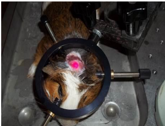
Рисунок 91 – Установка для исследования церебрального кровотока морской свинки методом спекл-имиджинга (а); изображение (отдельный фрейм) головного мозга морской свинки в системе спекл-имиджинга
