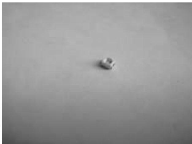
Рисунок 77 - Одномодовый VCSEL лазер, \lambda=850 нм
