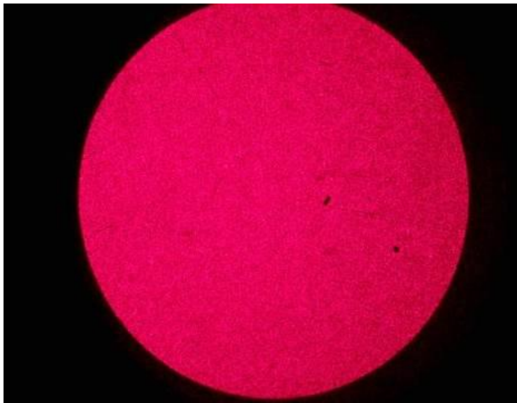
Рисунок 18 – Спекл-поле, наблюдаемое в когерентном микроскопе при рассеянии когерентного света на неподвижных бактериальных клетках
