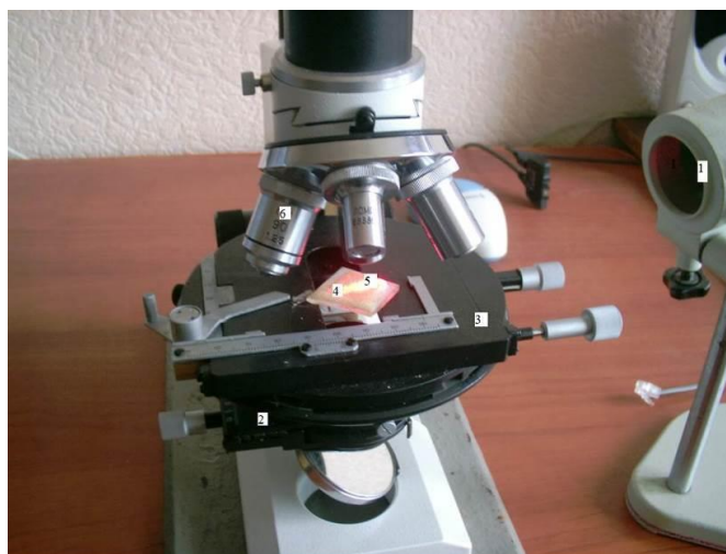
Рисунок 84 - Общий вид когерентного микроскопа для измерения размеров спеклов, формирующихся в бактериальной взвеси: 1 – освещающий лазерный пучок (мощность 3 мВт, длина волны 633 нм); 2 – конденсор; 3 – столик микроскопа; 4 – образец кожи; 5 – \times 95 микрообъектив с апертурой 1.25. Система формирования изображения, сопряжена с CMOS камерой Phoenix PC 1280 USB Digital Camera (MuTech, США)
