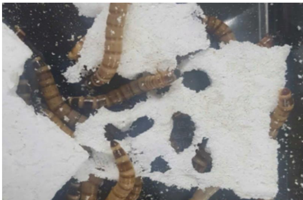
Рисунок 4 – Результат биодegradации полистирола
