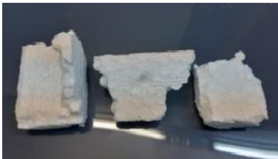
Рисунок 3 – Результат биодegradации пенополистирола
