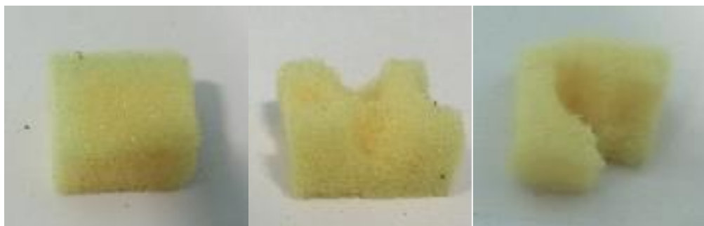
Рисунок 2 – Результат биодegradации эластичного пенополиуретана
