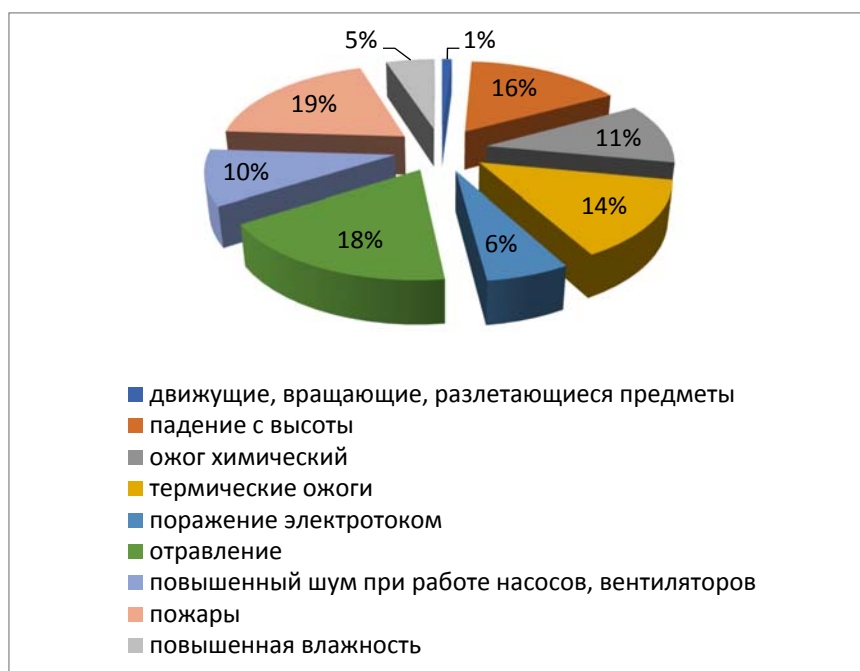
Рис. 2. Производственные факторы труда, повлекшие за собой вред здоровью работникам котельных в Тюменской области за 2020 год
