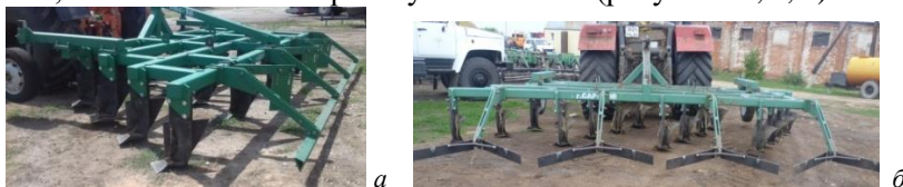
Рисунок 10 – Плуг ПБС-16-38 с приспособлениями: а - № 1; б - № 2
