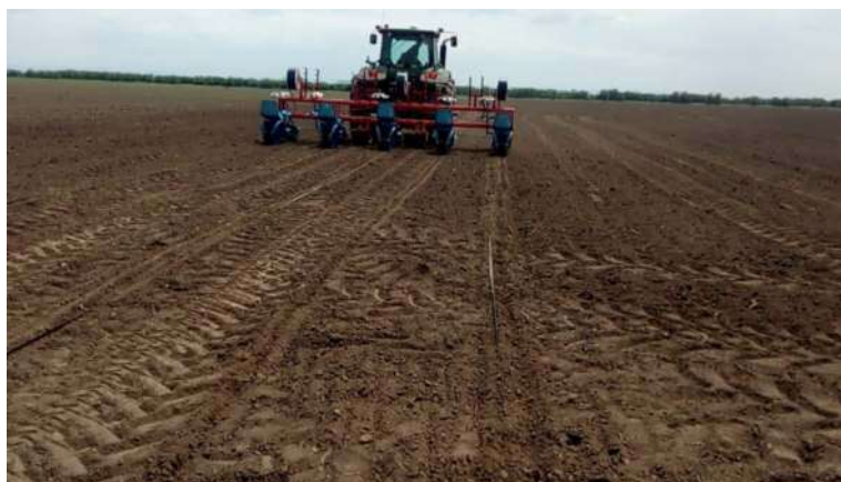
Рис.10. Рассадопосадочная машина Ferrari.
