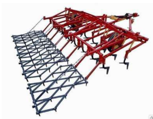
Рис.9. Сплошной культиватор серии КПС-4
