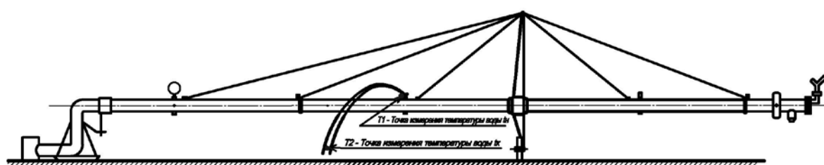
Рисунок 2 – Схема мест установки датчиков измерения температуры.
