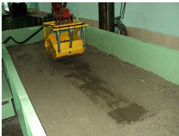
Рисунок 3 – Конструкция ковша скрепера с двуножевой системой загрузки ковша.
