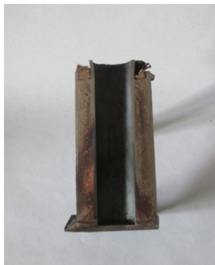
а – подготовленная форма; б – залитая и разрезанная форма с заготовкой Рисунок 1 – Литейная форма для пропитки сверху.
