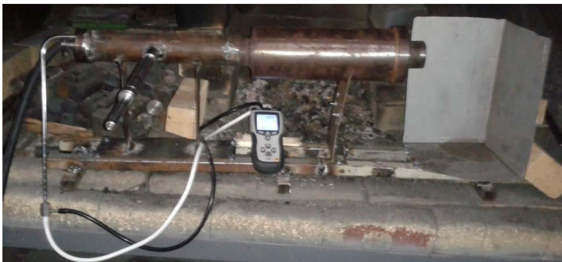
Рисунок 6 – Вид установки для определения искрогасящей способности сетчатого материала.
