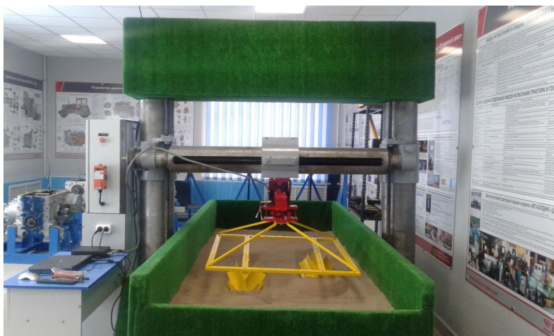
Рисунок 1 – Общий вид грунтового канала с установленным двухотвальным рабочим органом для нарезания минерализованных полос.
