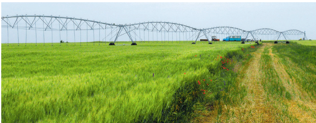
Рисунок 3 – Многоопорная дождевальная машина «ФРЕГАТ» с устройствами приповерхностного дождевания.
