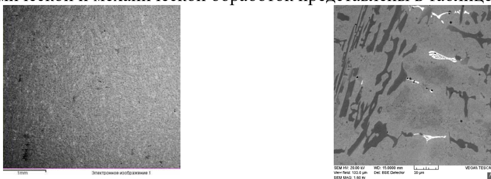
Рисунок 5 – Микроструктура образца из износостойкого чугуна ЧХ16М2 после отпуска (образец № 3).
