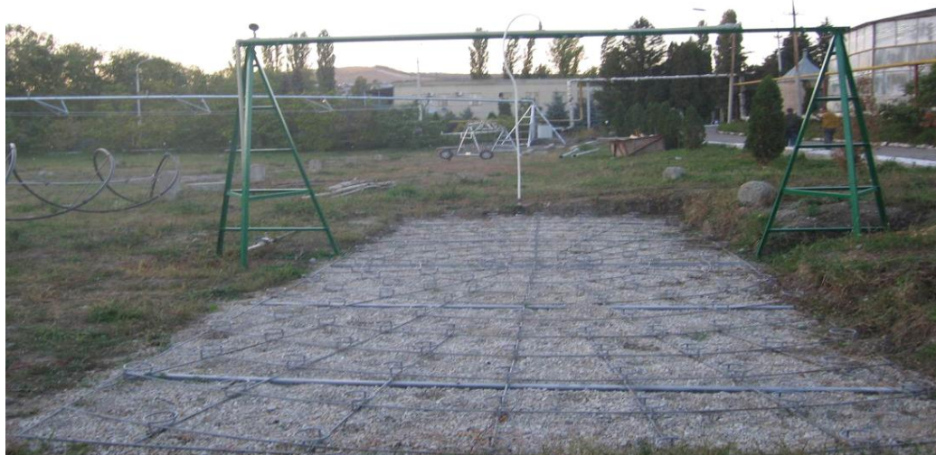
Рис. 4. Стенд для испытания дождевальных аппаратов и насадок.
