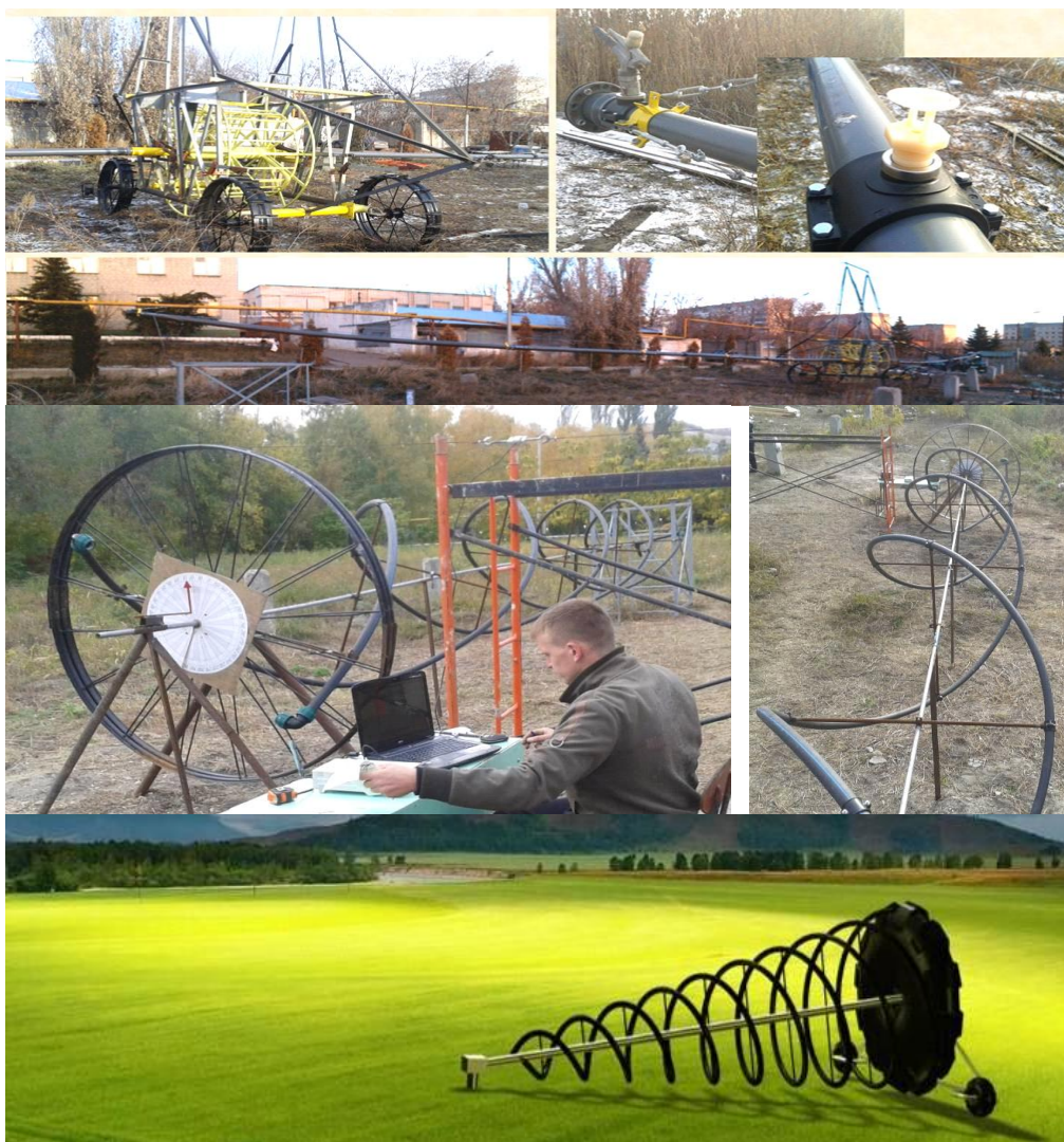
Рис. 3. Модели дождевальной техники с использованием полиэтиленового трубопровода
