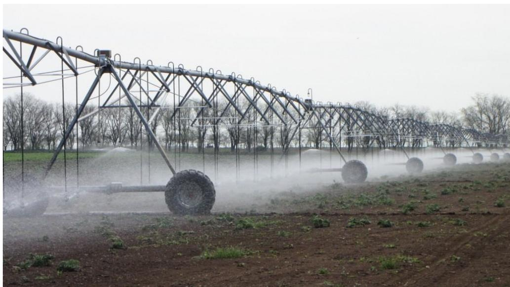
Рисунок 1. Дождевальная машина арочного типа
