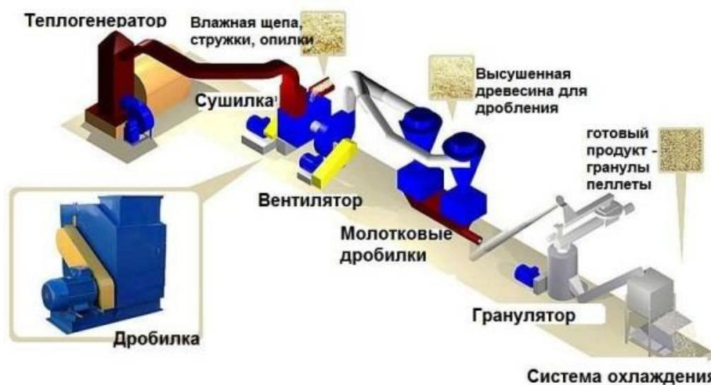
Рисунок 1. Схема технологической линии производства топливных гранул (пеллет).
