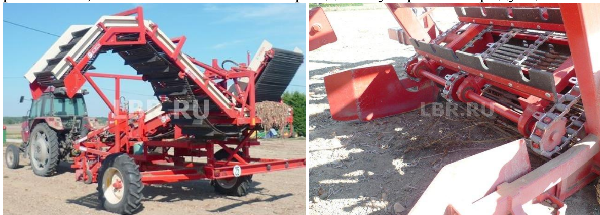
Рисунок 3 – Подборщик лука французской фирмы «Simon»: А – общий вид подборщика лука; Б – подбирающий транспортер
