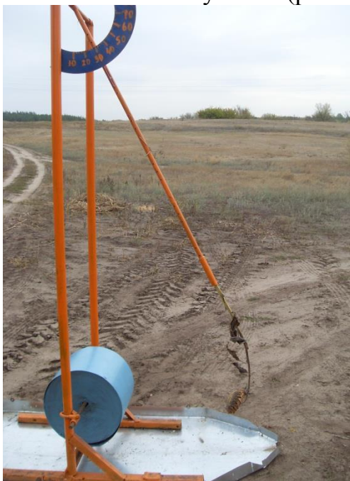
Рисунок 3. Проведение лабораторных опытов по исследованию осыпаемости семян подсолнечника
