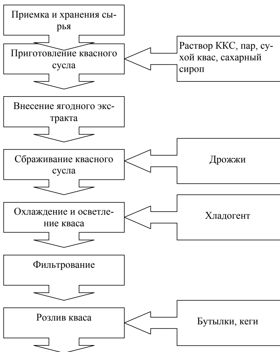
Рис. 5- Технологическая схема производства квасов «Живые витамины»
