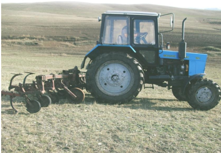
Рис. 2. Трактор МТ-82.1 с культиватором КРН-5,6В на склоне в процессе эксперимента
