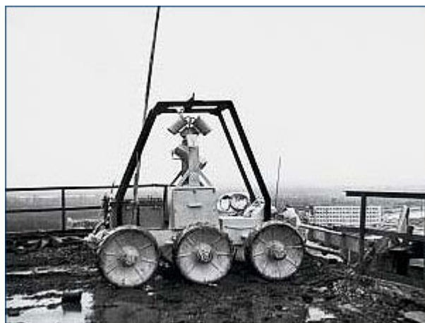
Робот СТР-1 выполнявший работы на крыше ЧАЭС
