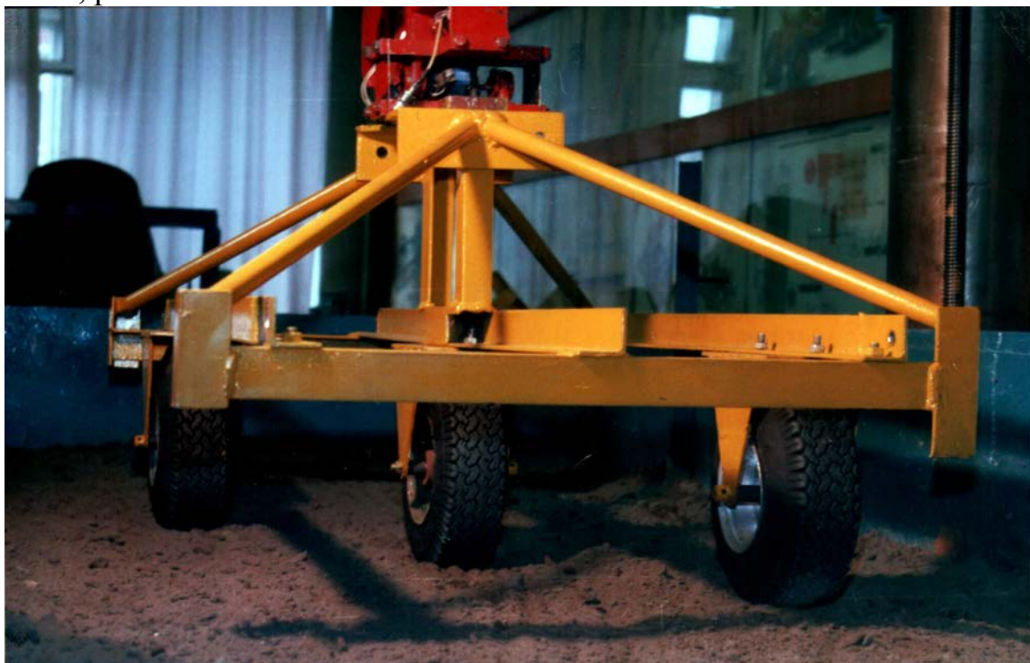
Рисунок 1. Лабораторная установка имитирующая ходовую систему трактора
