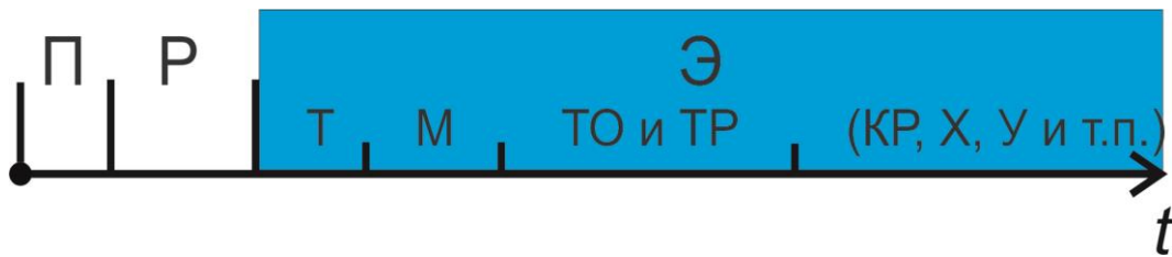
Рисунок 1.1 – Жизненный цикл электрооборудования: (П – проектирование; Р – разработка; Э – эксплуатация; Т – транспортирование; М – монтаж; ТО и ТР – техническое обслуживание и текущий ремонт; КР – капитальный ремонт, Х – хранение; У – утилизация
