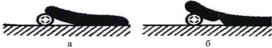
Рисунок 14 – Схема отделения загрязнения пульсирующими кавитационными пузырьками: а - начальный момент, б - момент разрыва и отделения
