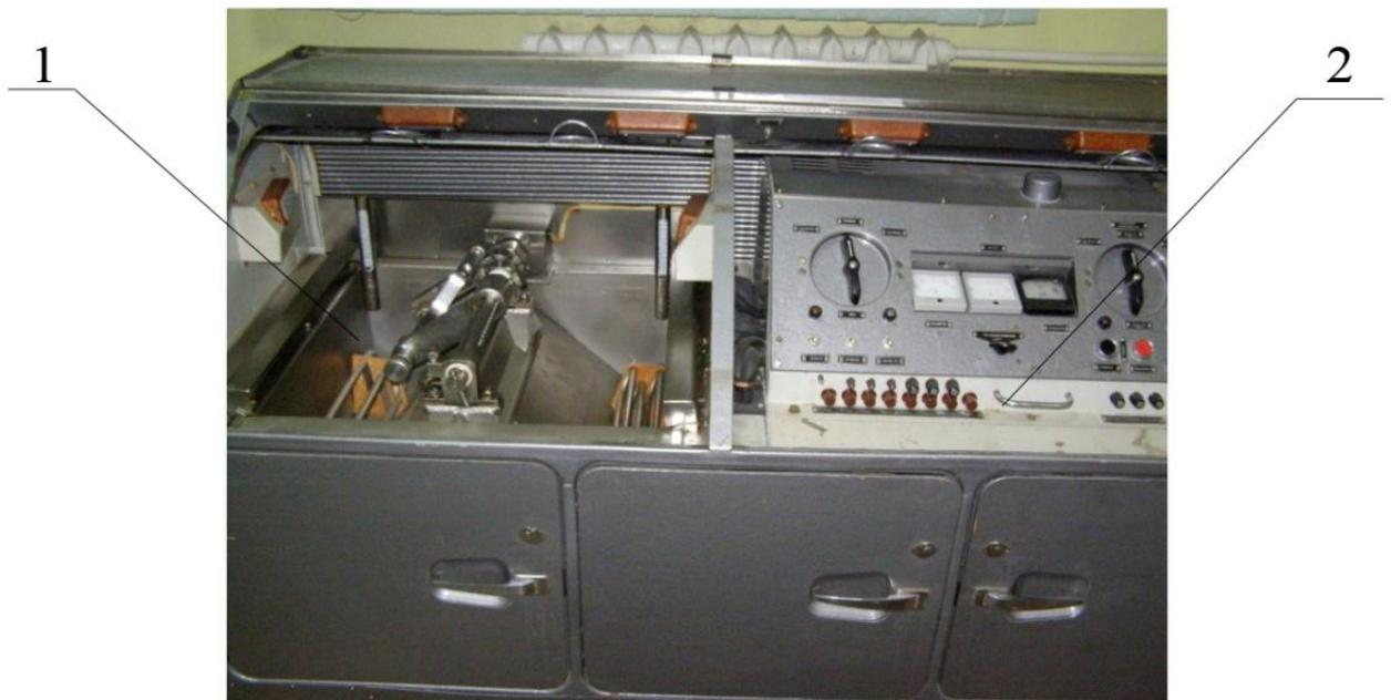
Рисунок 23 – Многопозиционная лабораторная ультразвуковая установка для отчистки и отволаживания зерна
