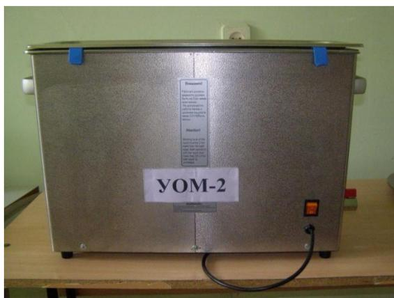
Рисунок 21 – Ультразвуковая ванна с регулируемой сменой воды
