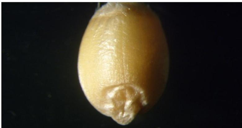
Рисунок 53 – Набухание зерна обработанного акустической кавитацией в течение 30 сек, (4 х)
