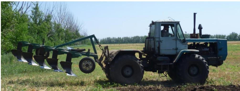
Рисунок 3.2 – Лемешно-отвальный плуг общего назначения ПБС-5М с трактором Т-150К
