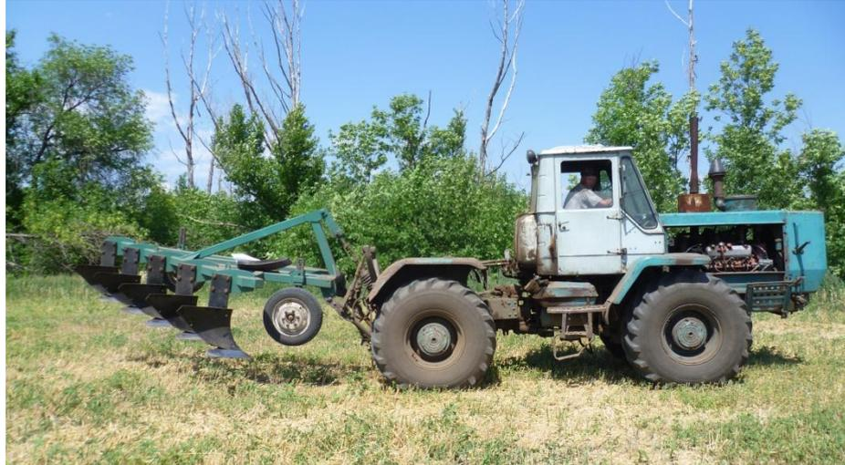
Рисунок 4.17 - Лемешно-отвальный плуг ПБС-5М в агрегате с трактором Т-150К
