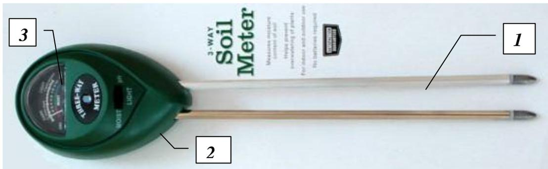
Рисунок 3.8 – Тестер влажности почвы ЭПА-103: 1- зонд; 2- корпус; 3- стрелочный циферблат
