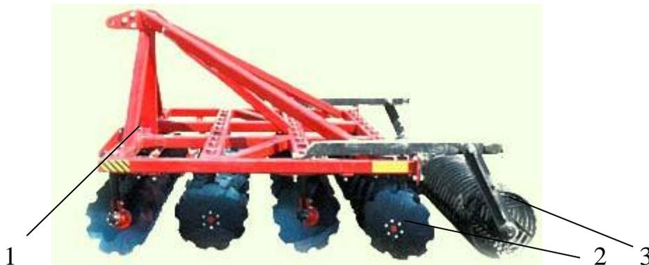
Рисунок 1.20 – Дискатор БДМ-4х4: 1 – рама; 2 – дисковый рабочий орган; 3 – каток
