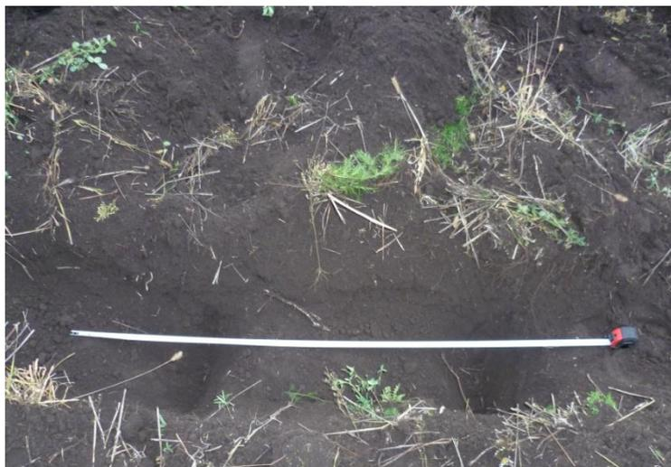
Рисунок 5.3 - Профиль обработанного слоя почвы плугом ПБФР-5
