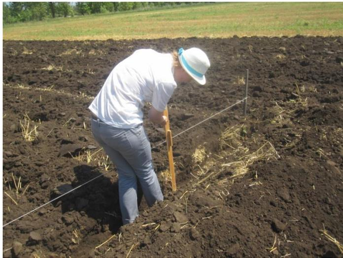
Рисунок 3.13 – Измерение профиля дна борозды
