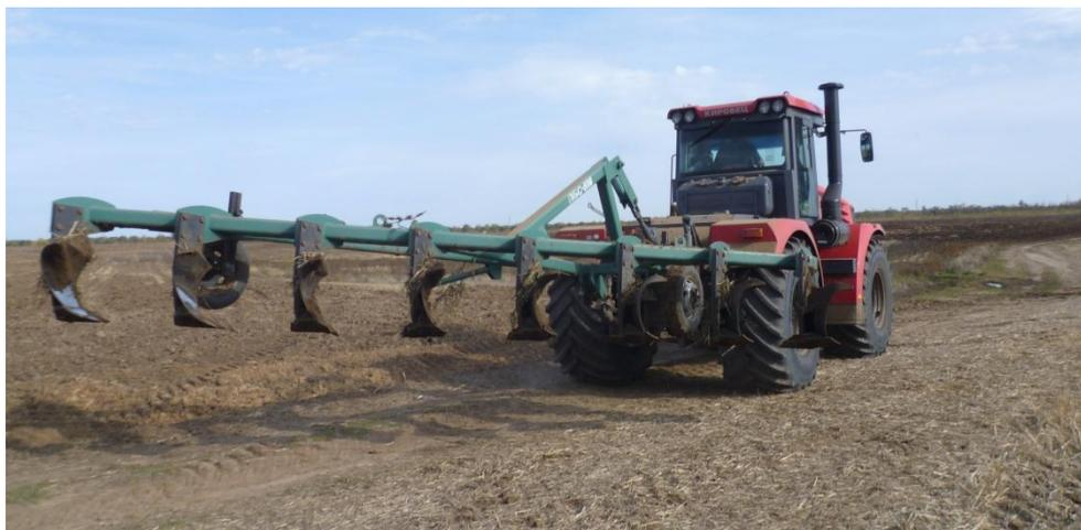
Рисунок 4.18 - Лемешно-отвальный плуг ПБС-8М в агрегате с трактором К-744РЗ
