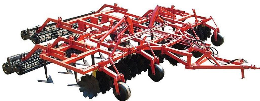
Рисунок 1.24 – Дисковатор-глубококорыхлитель ДГР-5.7
