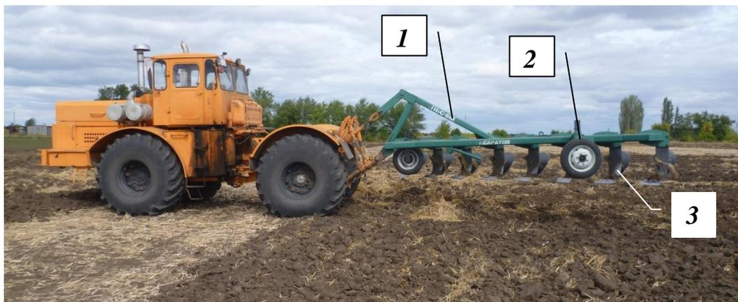
Рисунок 3.3 - Лемешно-отвальный плуг общего назначения ПБС-8М с трактором К-701:
