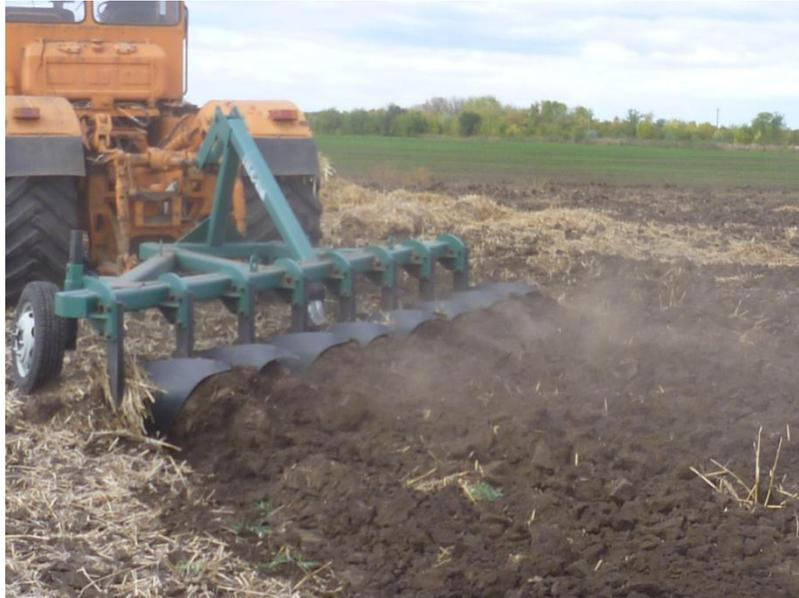
Рисунок 4.3 - Лемешно-отвальный плуг ПБС-8М в агрегате с трактором К-701 при обработке почвы
