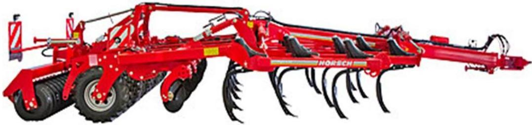
Рисунок 1.25 – Комбинированный культиватор Tiger AS фирмы HORSCH
