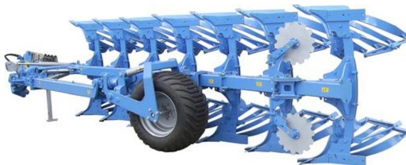
Рисунок 1.12 - Обратный плуг общего назначения Агат-П-7
