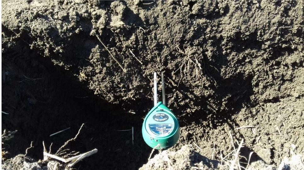
Рисунок 3.9 – Измерение влажности почвы тестером ЭПА-103
