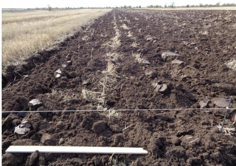
Рисунок 4.23 - Поверхность пашни после прохода плуга ПБС-8М (фон 2)
