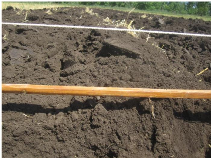
Рисунок 3.17 – Измерение гребнистости поверхности пашни
