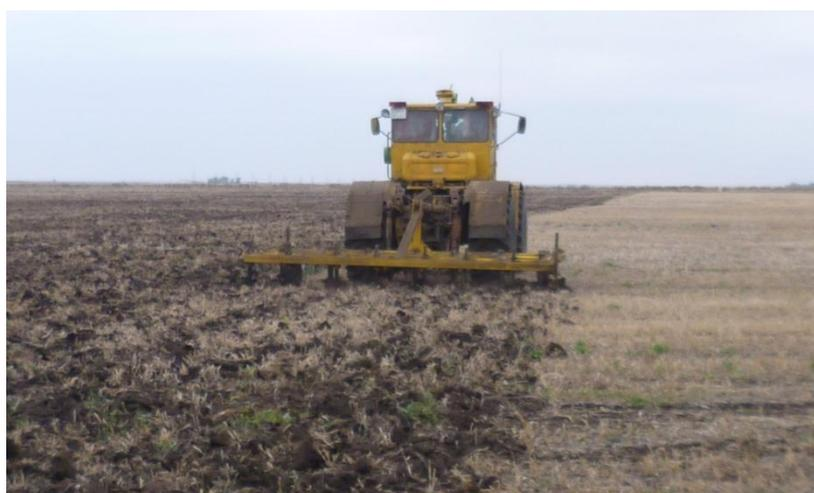
Рисунок 4.5 - Фронтальный плуг-рыхлитель ПБФР-5 в агрегате с трактором К-701 при обработке почвы
