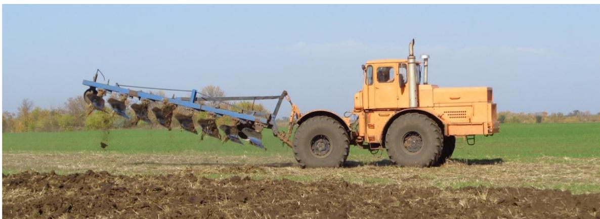
Рисунок 3.1 – Лемешно-отвальный плуг общего назначения ПНЛ-8-40 с трактором К-701
