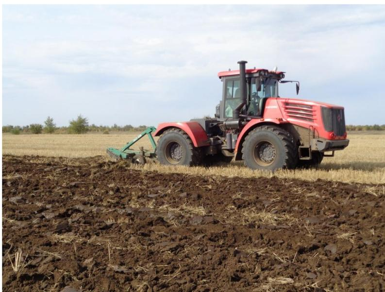
Рисунок 4.21 - Пахотный агрегат К-744Р3+ПБС-8М при обработке поля после уборки проса (фон 2)
