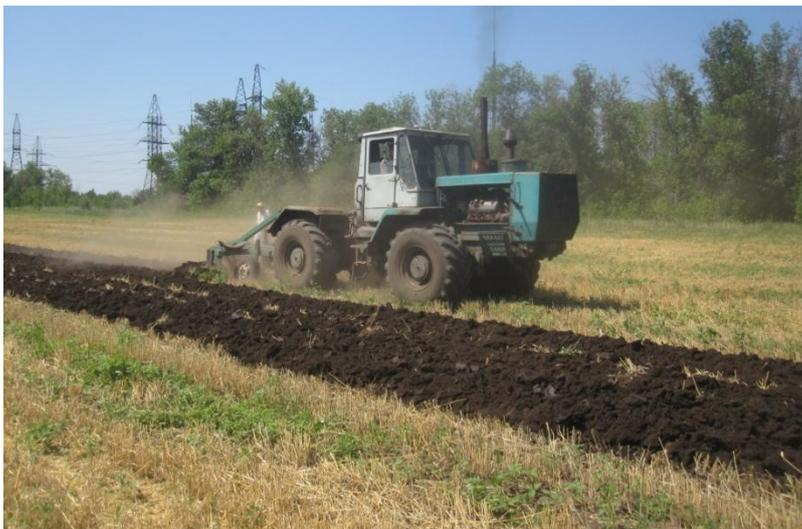
Рисунок 4.20 - Пахотный агрегат Т-150К+ПБС-5М при обработке поля после уборки озимой пшеницы (фон 3)
