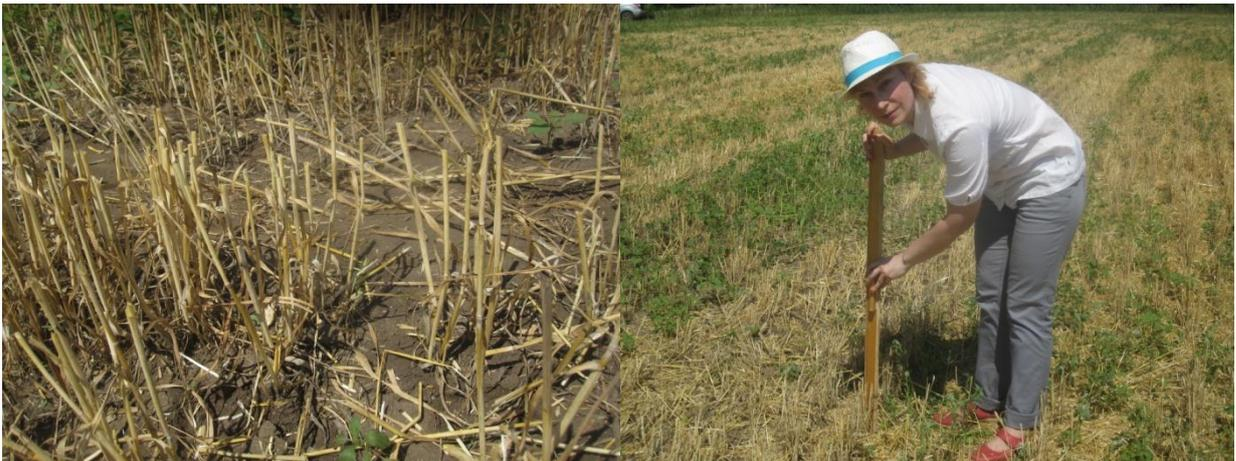
Рисунок 3.10 – Измерение высоты стерни озимой пшеницы
