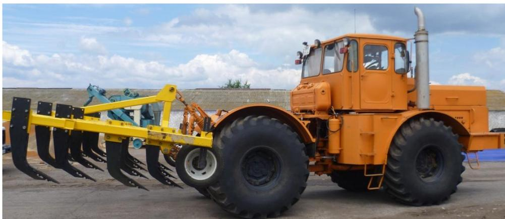
Рисунок 2.19 – Фронтальный плуг-рыхлитель ПБФР-5 в агрегате с трактором К-701
