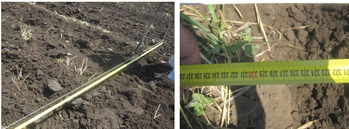
Рисунок 3.16 – Измерение ширины захвата плуга
