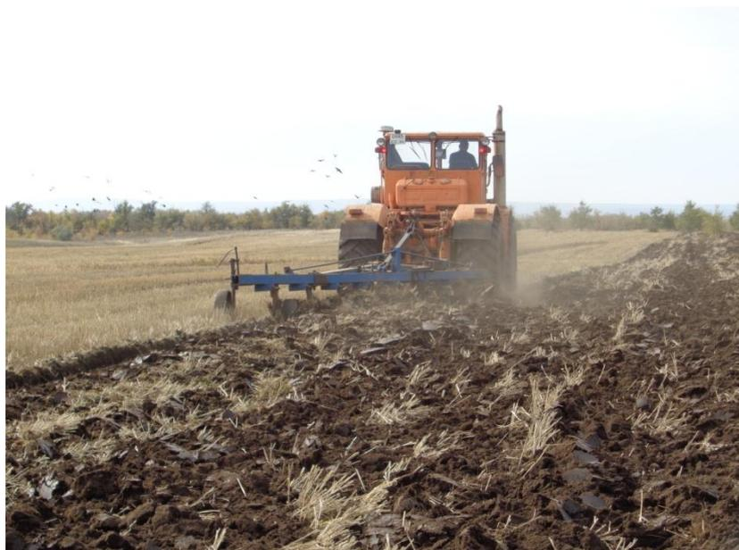
Рисунок 4.10 - Пахотный агрегат К-701+ПНЛ-8-40 при обработке поля после проса.
