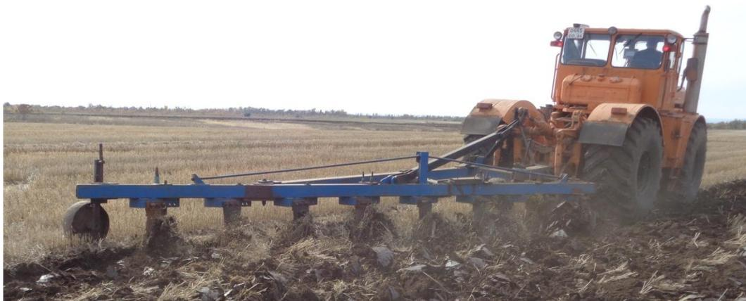
Рисунок 4.1 - Лемешно-отвальный плуг ПНЛ-8-40 в агрегате с трактором К-701 при обработке почвы
