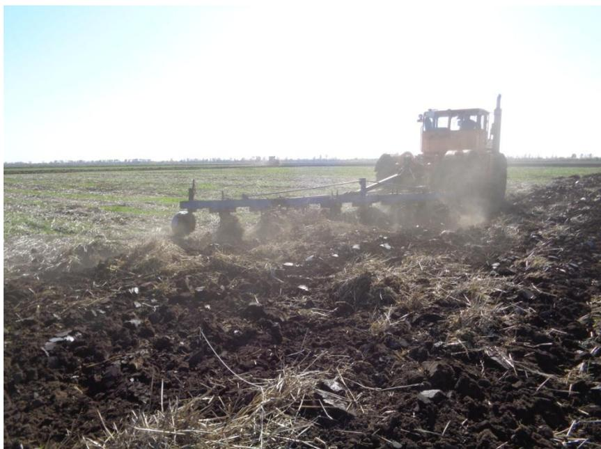
Рисунок 4.9 - Пахотный агрегат К-701+ПНЛ-8-40 при обработке поля после озимой пшеницы
