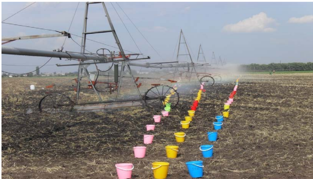
Рисунок 3.8 – Расстановка мерных емкостей для исследования равномерности и качества полива ДМ «Фрегат»
