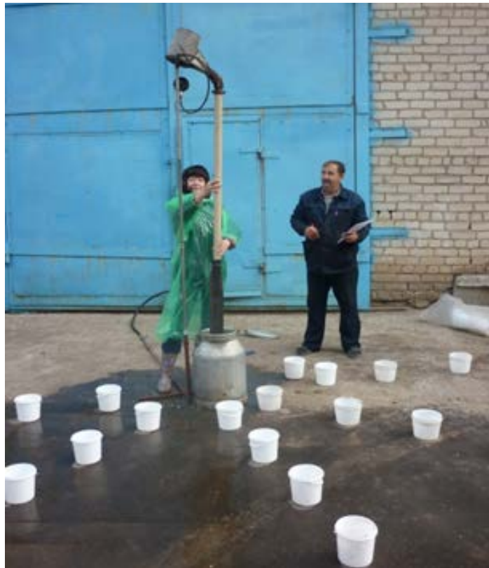
Рисунок 3.2 – Определение расходных характеристик дождевальных насадок с помощью мерного бака
