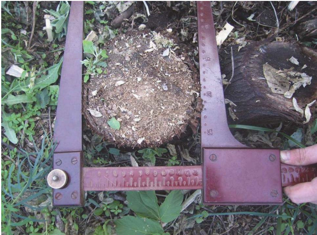
Рисунок 3.1 – Определение размерных характеристик пней, оставшихся после срезания древесно-кустарниковой растительности на оросительных каналах
