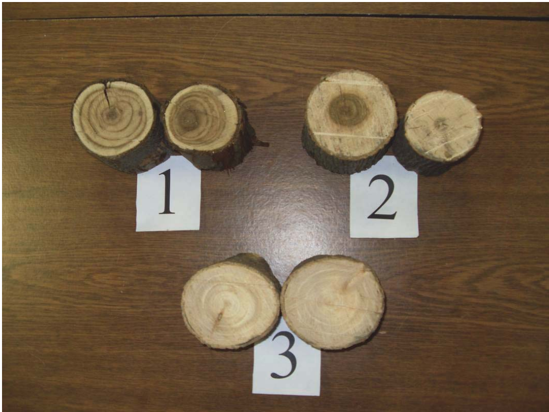
Рисунок 3.6. Образцы распространенных на каналах пород древесины, используемых для исследований.
