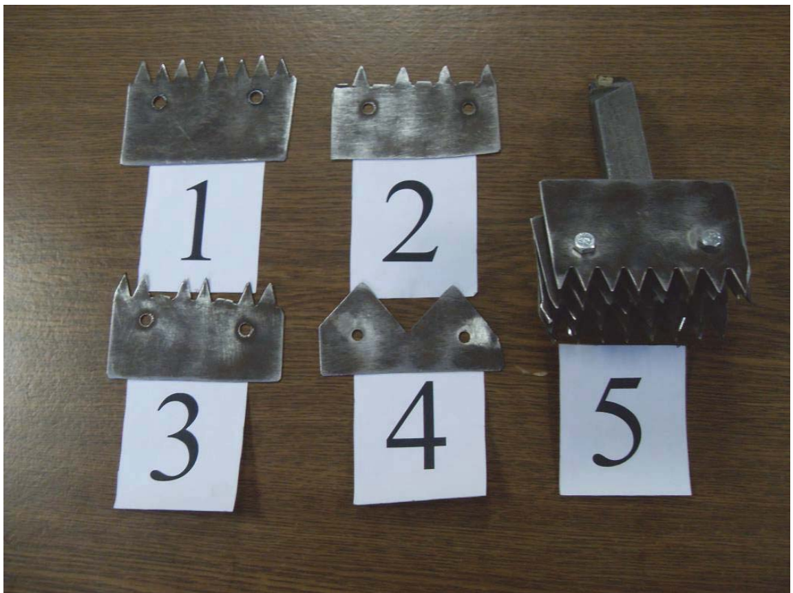
Рисунок 3.5 – Пластины с различными геометрическими параметрами зубьев
