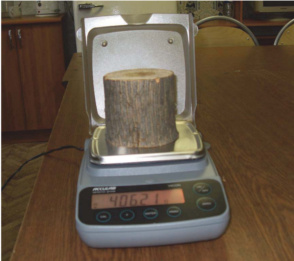
Рисунок 3.7 – Взвешивание образцов древесины с помощью электронных весов
