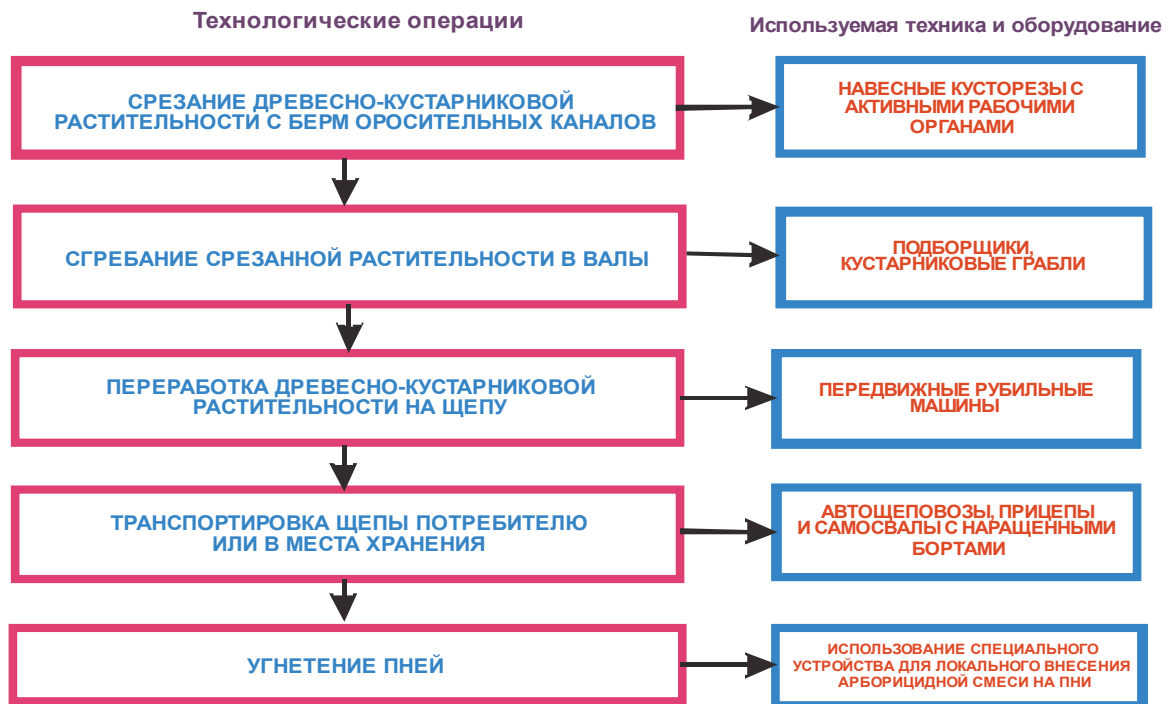
Рисунок 1.8 – Усовершенствованная технология удаления древесно-кустарниковой растительности вдоль каналов
