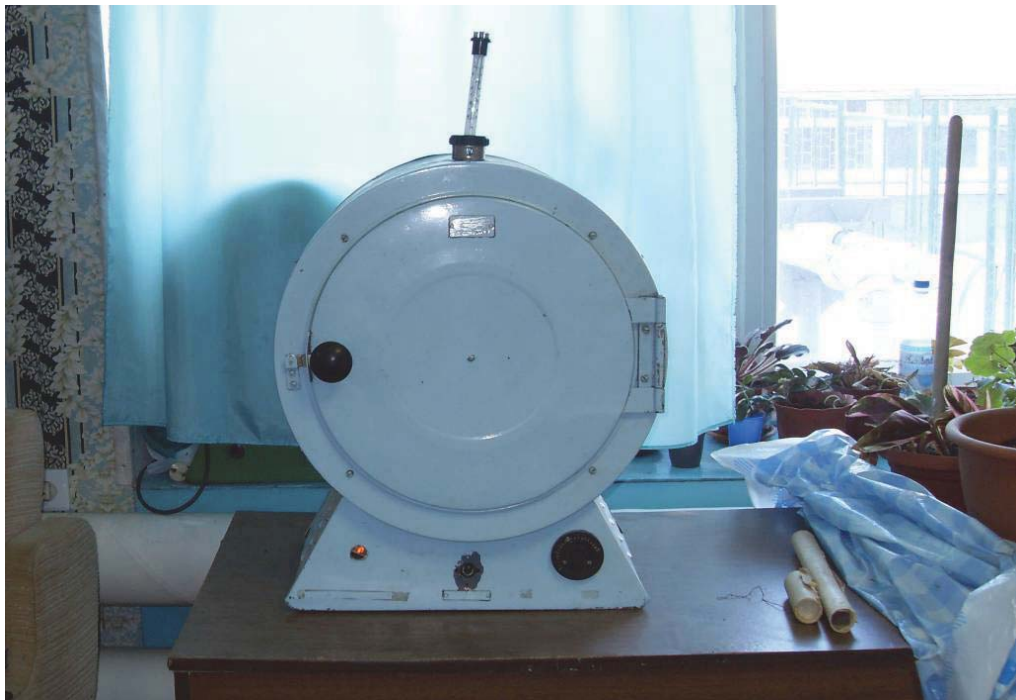
Рисунок 3.8 – Сушка образцов древесины в сушильном шкафе СУ-2М
