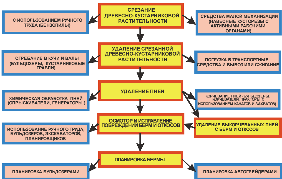
Рисунок 1.7 – Существующая технология очистки оросительных каналов от древесно-кустарниковой растительности
