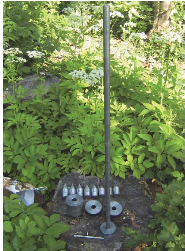
Рисунок 3.10 – Экспериментальная установка с набором сменных наконечников и ударных шайб
