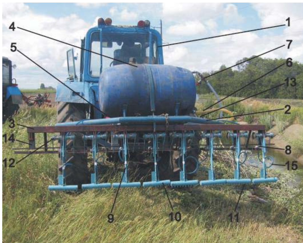
Рисунок 3.11 – Устройство для локального внесения арборицидной смеси на пни: 1 – базовый трактор; 2, 3 – рама; 4 – бочка; 5 – насос; 6 – магистраль; 7 – перепускной клапан; 8 – клапан; 9 – рабочий орган; 10 – трубка; 11 – зубья; 12 – пружина; 13 – коллектор; 14 – стопор; 15 – шланг
