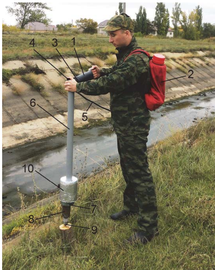
Рисунок 3.12 – Устройство инъекционного типа для локального угнетения пней: 1 – насос ручной; 2 – канистра ранцевая; 3, 4 – клапаны обратные; 5 – шланг соединительный; 6 – корпус инъектора; 7 – шайба упорная; 8 – насадка; 9 – наконечник; 10 – шайба ударная
