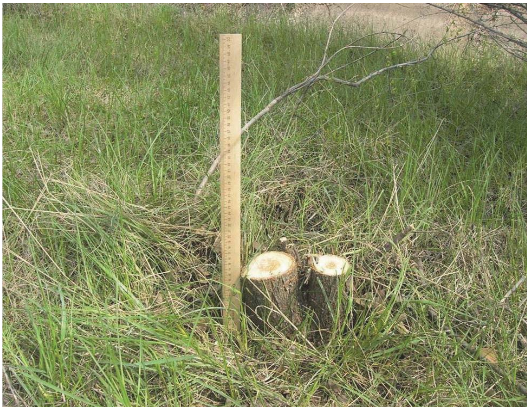
Рисунок 3.2 – Измерение высоты пня после срезания древесно-кустарниковой растительности кусторезом
