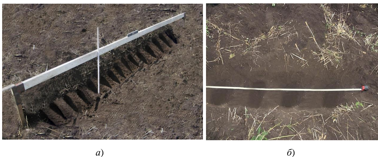
Рисунок 3.9 – Фотографии: а - профилирование обработанного слоя почвы экспериментальным фронтальным плугом-рыхлителем с чизельными рабочими органами; б - измерение расстояния между углублениями борозд после прохода рабочих органов
