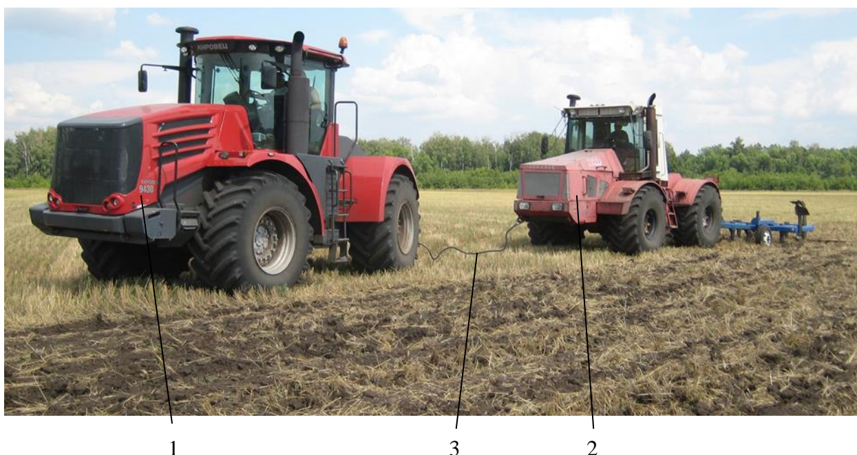
Рисунок 3.13 - Фотографии исследований пахотного агрегата: 1 – трактор К-9430 с тензобалкой; 2 – трактор К-744Р1 агрегируемый с экспериментальным фронтальным плугом-рыхлителем; 3 – трос
