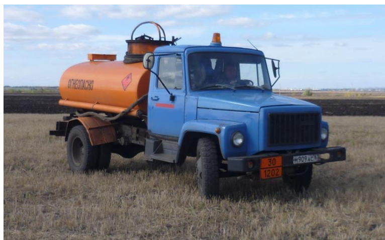
Рисунок 3.18 – Топливозаправщик для обеспечения заправки топливного бака трактора в начале смены и дозаправки в конце смены
