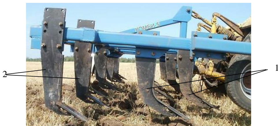
Рисунок 3.3 – Экспериментальный фронтальный плуг-рыхлитель (вид справа): 1 – чизельные рабочие органы с криволинейной стойкой и грудкой (установлены на 1 и 2 рядах); 2 – чизельные рабочие органы с прямой стойкой и обтекателем (установлены на 3 и 4 рядах).
