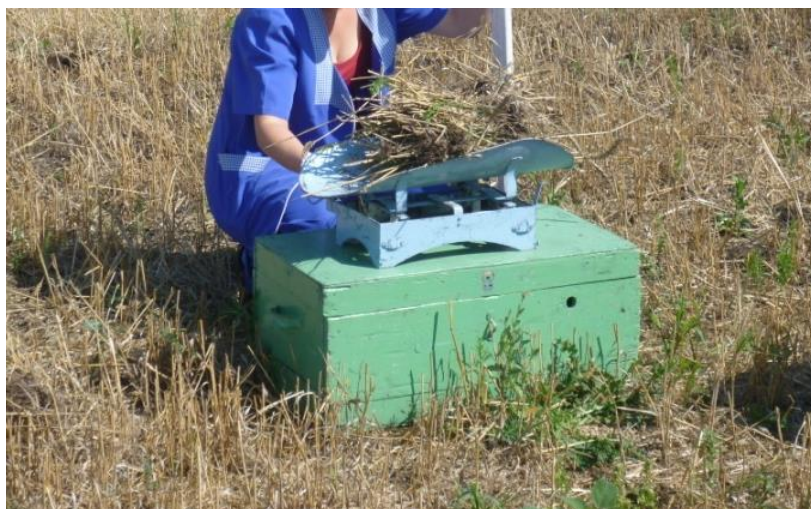
Рисунок 3.11 - Взвешивание пожнивных и растительных остатков, собранных с исследуемой площади до прохода экспериментального фронтального плуга-рыхлителя
