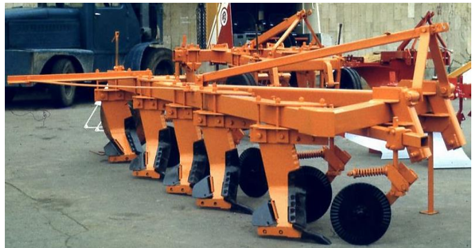
Рисунок 1.10 - Плуг-рыхлитель ПРПВ-5-50 с наклонными стойками типа «Параплау»
