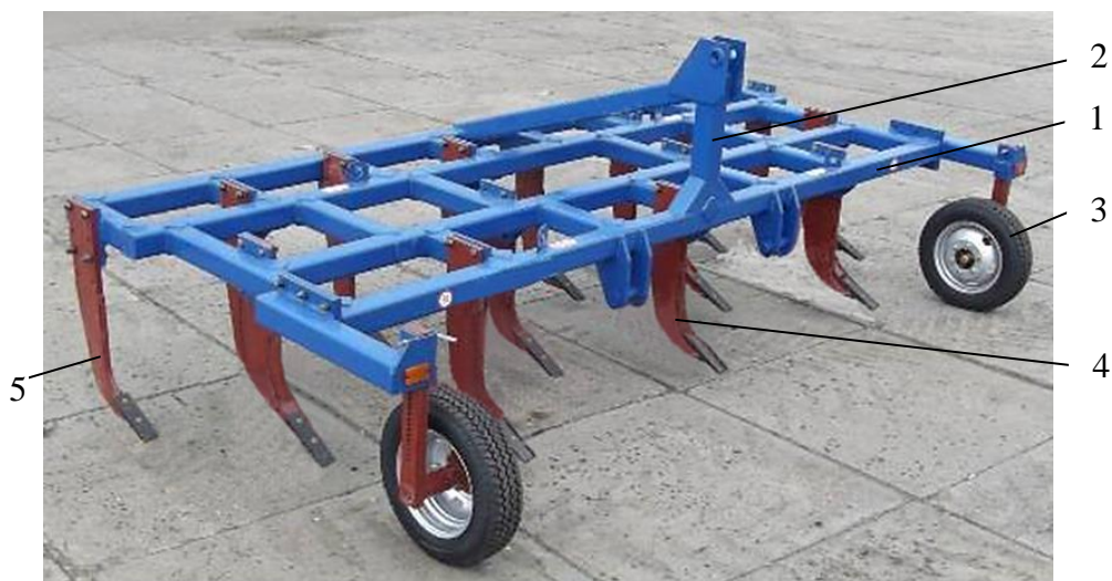
Рисунок 3.1 - Экспериментальный фронтальный плуг-рыхлитель: 1 – рама; 2 – навесное устройство; 3 - опорные колесо с механизмом регулировки глубины обработки почвы; 4 – чизельные рабочие органы с криволинейной стойкой и грудкой; 5 – чизельные рабочие органы с прямой стойкой
