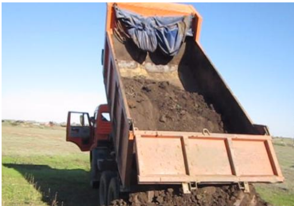
Рисунок 1.12 – Неполная разгрузка кузова транспортного средства
