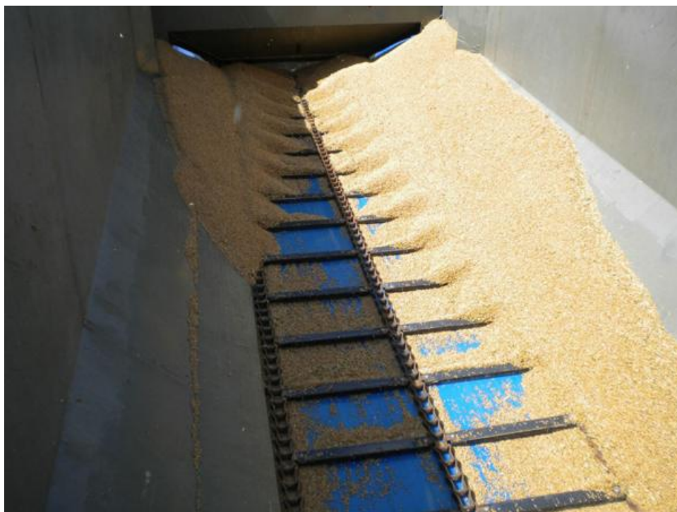
Рисунок 1.20 – Прицеп с донными скребками на тяговой цепи («ТОНАР»)
