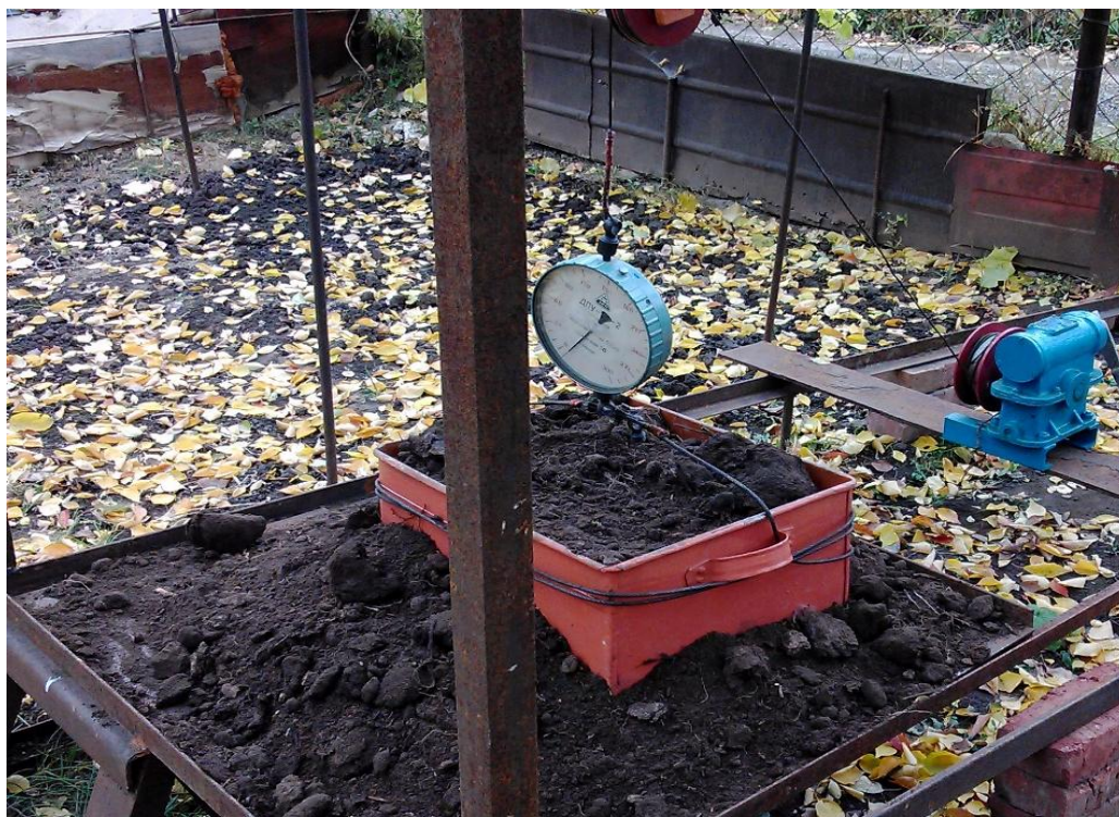
Рисунок 4.1 –Установка по исследованию липкости
