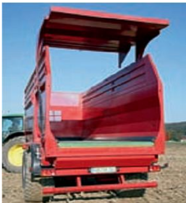
Рисунок 1.18 – Прицеп с конвейерной лентой (Krampebandit 650)
