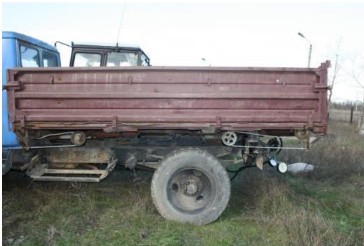
Рисунок 3.4 – Лабораторная установка – кузов с активизатором разгрузки: а – общий вид; б – вид сбоку
