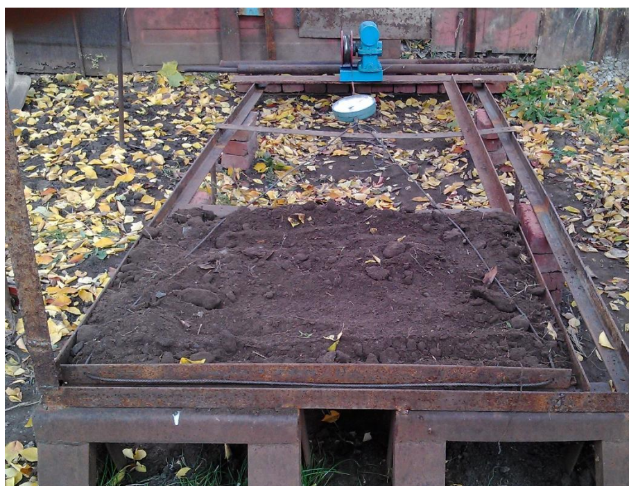
Рисунок 4.4 – Установка по определению усилия, затрачиваемого на перемещение скребка
