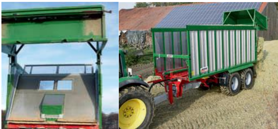
Рисунок 1.14 – Прицеп с гидравлическим устройством (Kroeger TAW 20)
