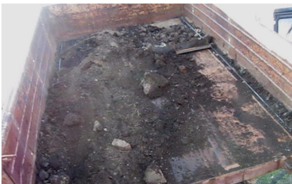
Рисунок 4.10 – Перебрасывание части груза через заднюю стенку скребка при увеличении скорости подачи скребка
