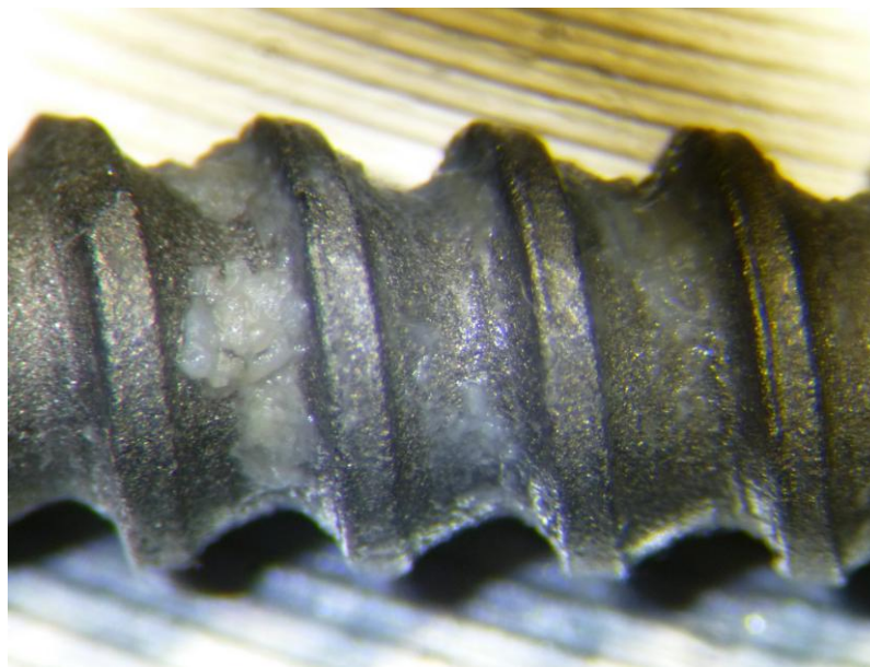
Рисунок 13. Внешний вид имплантата после извлечения из кости при увеличении под лупой ( \times 5 ).
