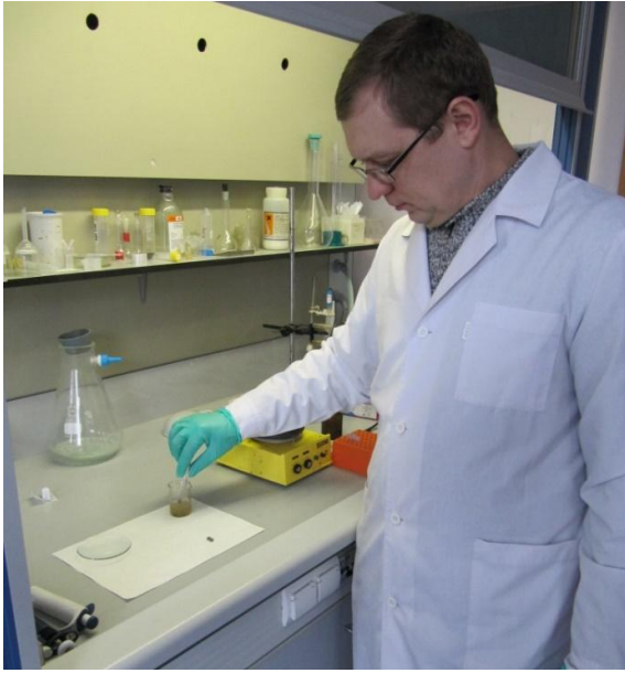
Рисунок 47. Нанесение композитного покрытия методом погружения
