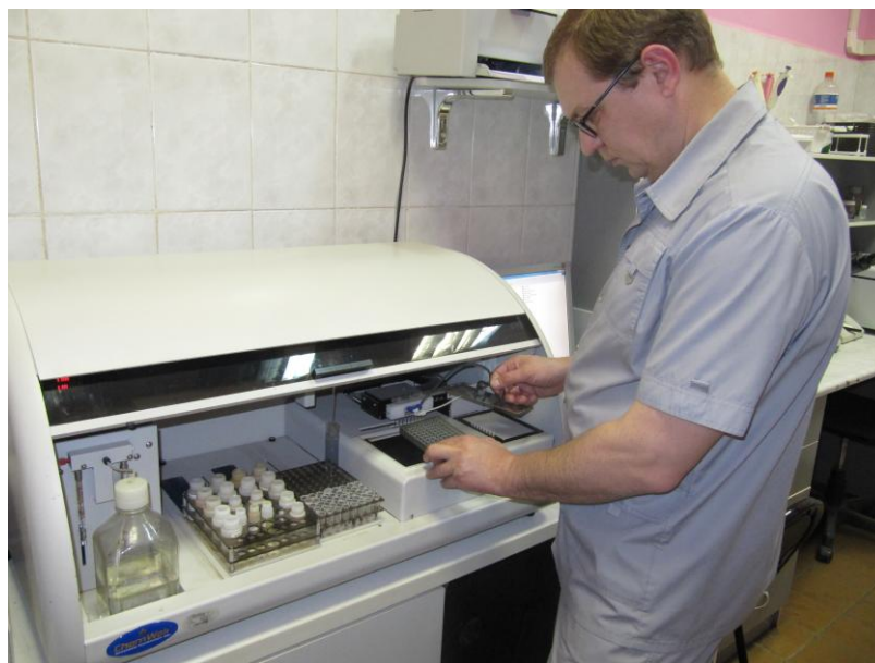
Рисунок 12. Определение цитокинового профиля на автоматическом иммуноферментном анализаторе Chem Well 2910 (Combi).
