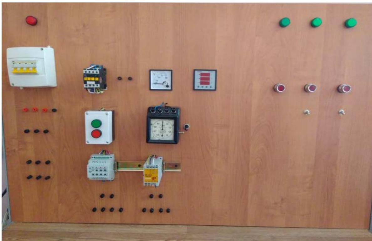
Стенд предназначен для испытания и сравнения характеристик низковольтной пуско-защитной аппаратуры. Будет использоваться в учебном процессе в лаборатории 420 "Эксплуатация электротехнологического оборудования".
