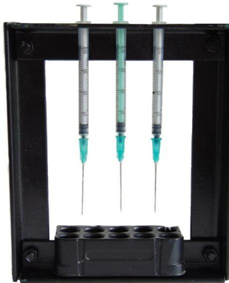
Рисунок 3 – Устройство для нескольких капиллярных вискозиметров.
