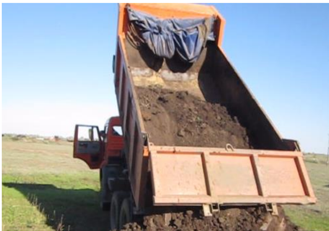
Рисунок 1.12 – Неполная разгрузка кузова транспортного средства
