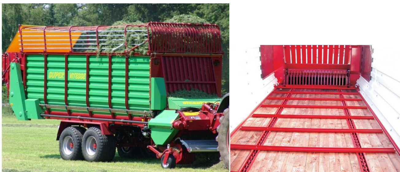
Рисунок 1.16 – Прицеп с цепным устройством (Gigatrailer)
