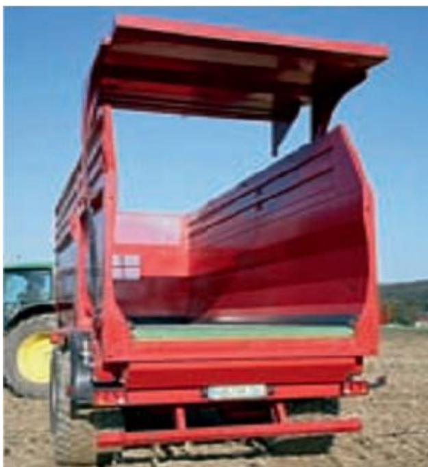
Рисунок 1.18 – Прицеп с конвейерной лентой (Krampebandit 650)
