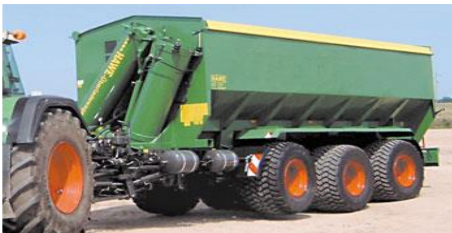
Рисунок 1.19 – Прицеп с винтовым устройством подачи (ГК ООО «Агромолтехника»)
