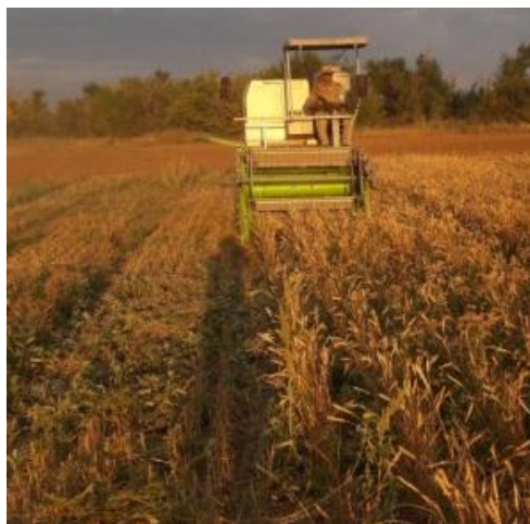
Рисунок 3.31 – Малогабаритный селекционный комбайн «WINTERSTEIGER» на скашивании и обмолоте опытной делянки
