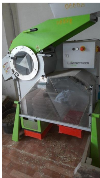
Рисунок 3.32 – Молотильная установка «WINTERSTEIGER» для обмолота снопов: a – общий вид; б – обмолоченное зерно
