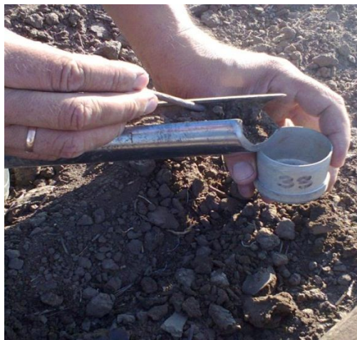
Рисунок 3.22 – Отбор почвенных проб: а – игольчатый бур; б – извлечение почвы из полости бура и переноска его в бюкс; в – бюксы
