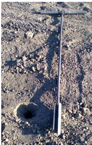
Рисунок 3.22 – Отбор почвенных проб: а – игольчатый бур; б – извлечение почвы из полости бура и переноска его в бюкс; в – бюксы
