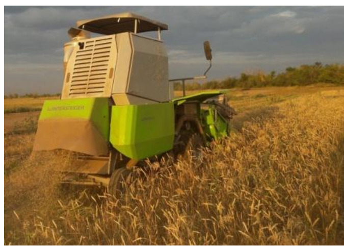
Рисунок 3.31 – Малогабаритный селекционный комбайн «WINTERSTEIGER» на скашивании и обмолоте опытной делянки
