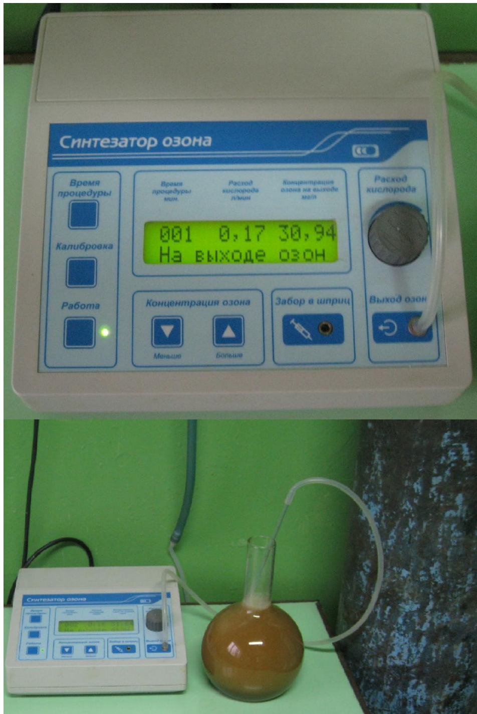
Рисунок 1 – Внешний вид генератора озона «А-с-ГОКСф-5-02-озон» и процесс барботирования озонкислородной смесью эмульсии состоящей из гинодиксина и рыбьего жира
