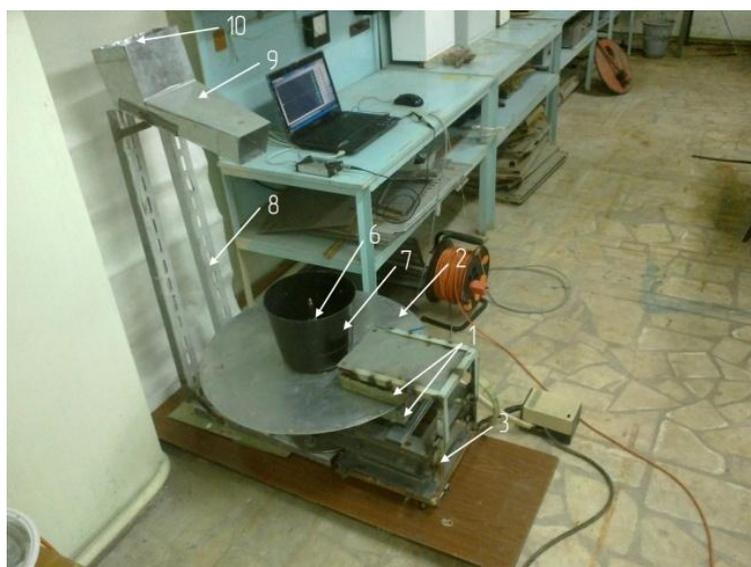
Рисунок 4.2 Общий вид экспериментальной жерновой мельницы с ЛЭП
