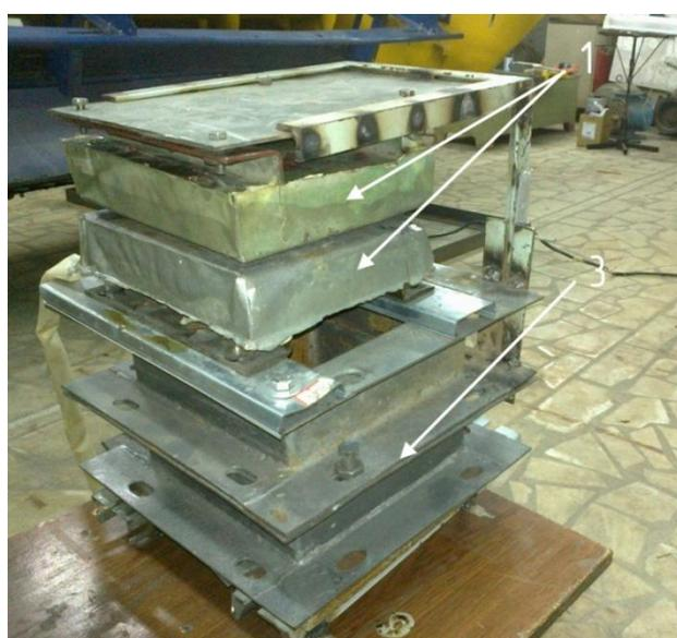
Рисунок 4.4 Двухсторонний плоский линейный асинхронный двигатель (1), закрепленный на тележке (3)
