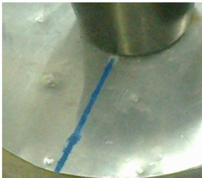
Рисунок 4.6 Отражательная метка, в виде полосы синей краски.
