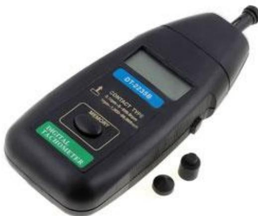
Рисунок 4.7 Цифровой тахометр JM-DT-2235B
