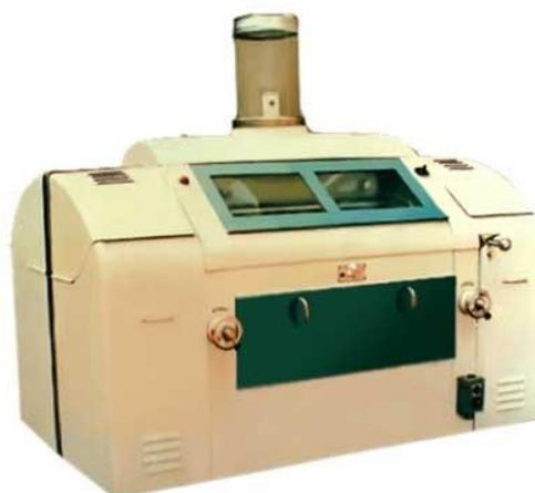
Рисунок 1.3 Вальцовый станок марки А1-ЗБН
