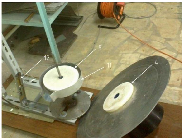
Рисунок 4.3 Жернова, разгрузочный лоток и датчик
