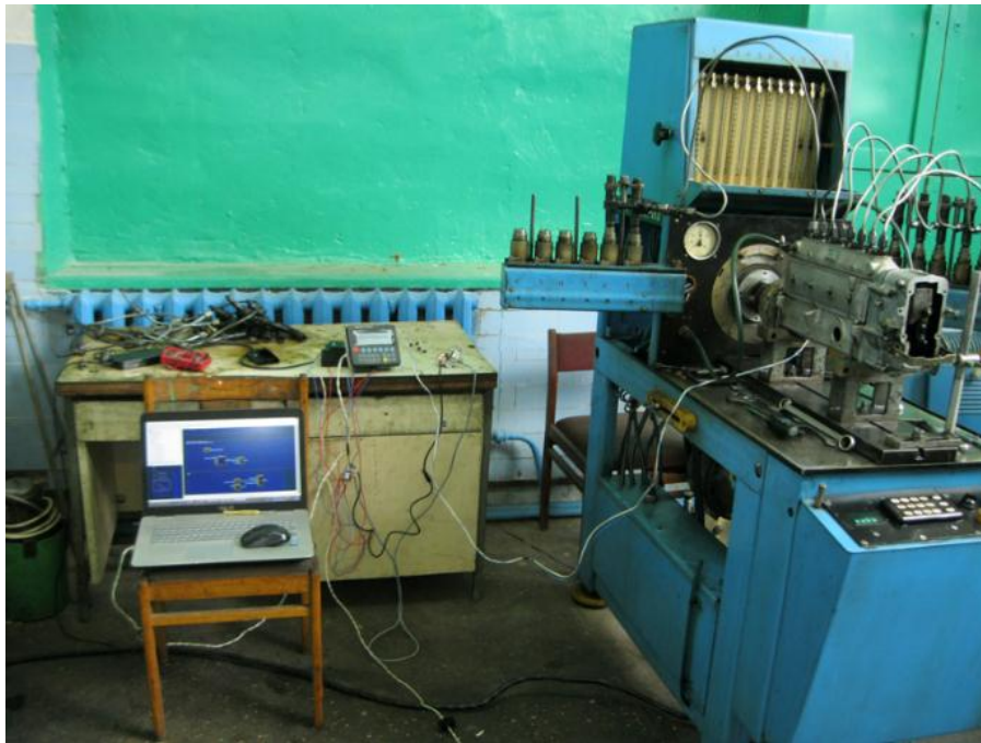
Рисунок 6 – Общий вид стенда по регулировке топливной аппаратуры КИ-22010
