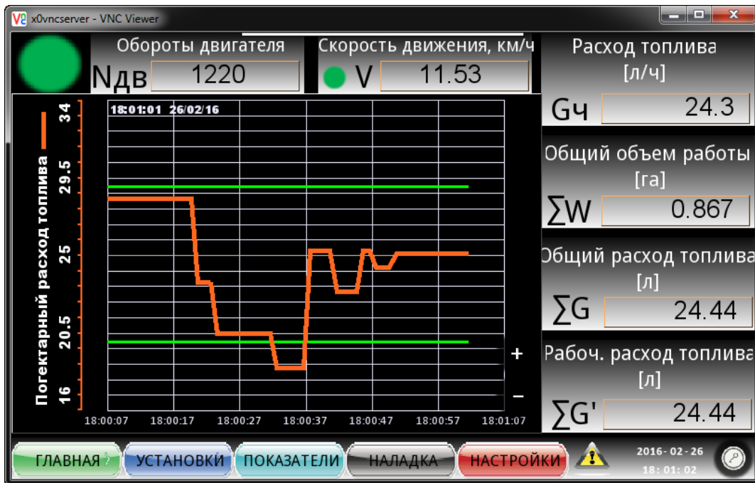
Рисунок 5 – Экран панели оператора (работа)
