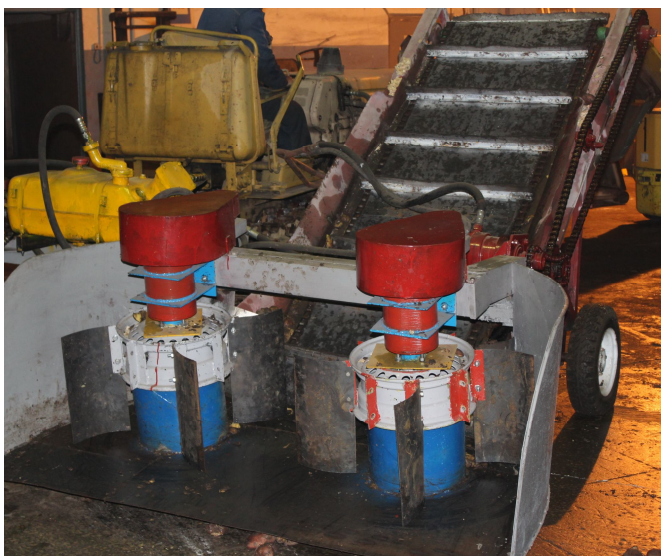
Рисунок 3 – опытный образец погрузчика с напорно-лопастным питателем.
