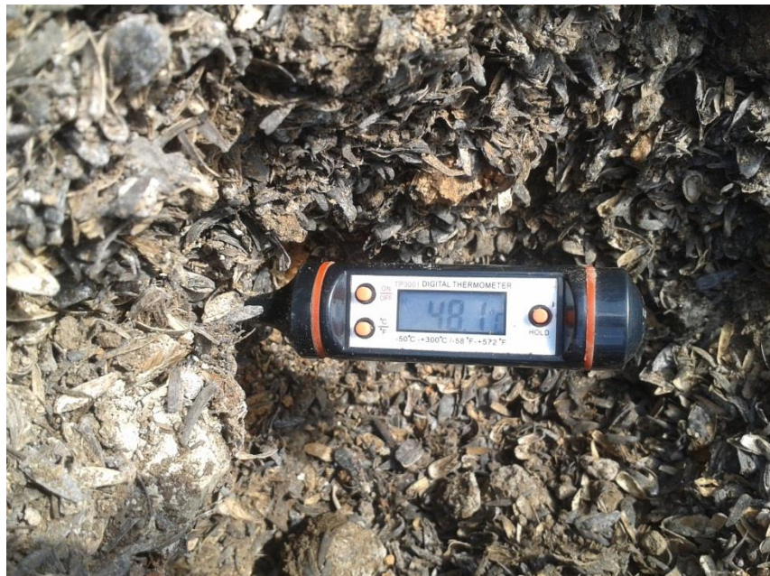
Рисунок 3.9 – Измерение температуры с помощью электронного термометра
