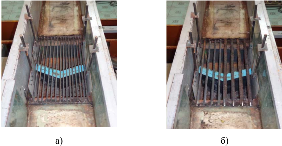
Рис. 2. Натурные модели вододелителя ВДКБТ-1: а) с асимметричной решеткой с разным зазором между прутьями решетки; б) с асимметричной решетчатой плитой с равными расстояниями между пластинами, но с разной шириной прутьев решетки
