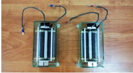
Рисунок 10 – Рабочий и эталонный конденсаторы для лабораторных исследований
