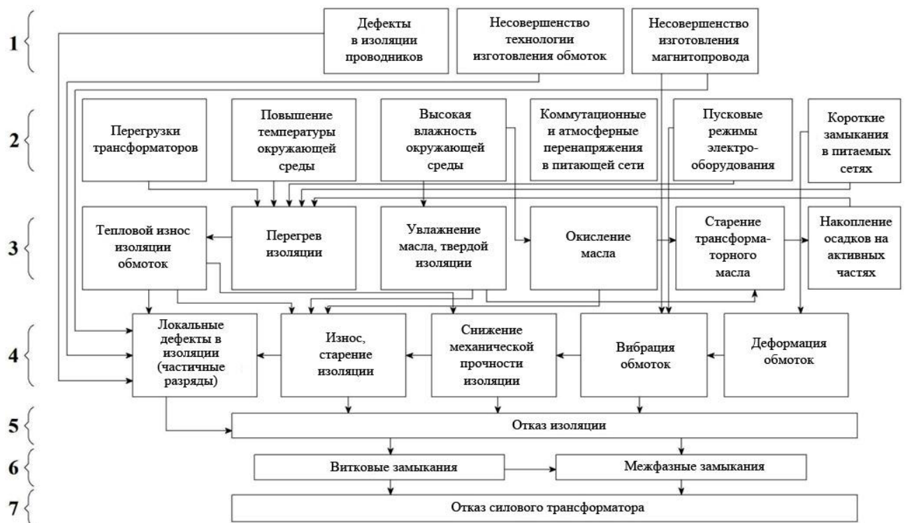
Рисунок 1.1 – Схема развития повреждений изоляции трансформаторов:
