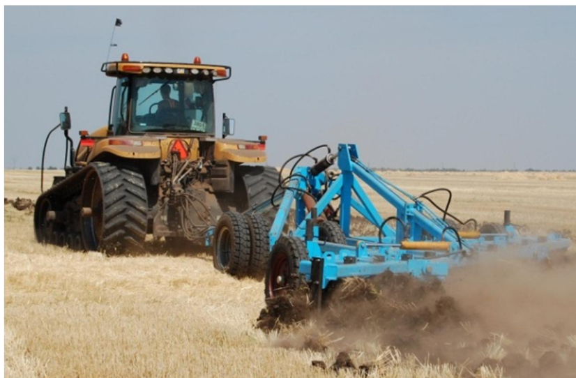
Рисунок 12 - Пахотный агрегат Challenger MT865В + ПБС-12П, выполняющий основную обработку почвы
