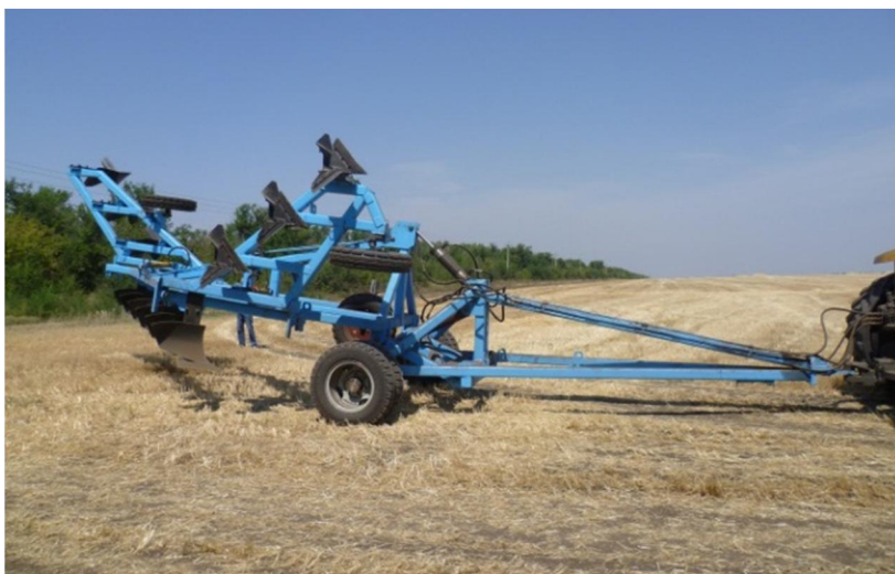
Рисунок 11 - Прицепной плуг ПБС-12П в транспортном положении
