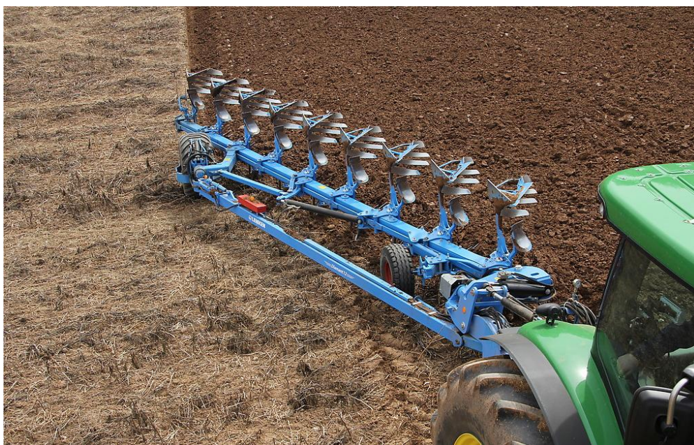
Рисунок 1.12 - Немецкий полунавесной плуг Lemken Diamant 12 в агрегате с трактором John Deere, выполненный по схеме с опорой на колесо
