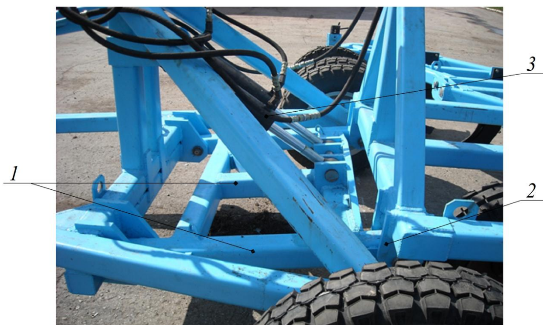
Рисунок 3.3 - Плуг ПБС-12П. Рамка механизма подъема лафета: 1 – продольные брусья, 2 – понизители навесного устройства плуга, 3 – гидроцилиндры
