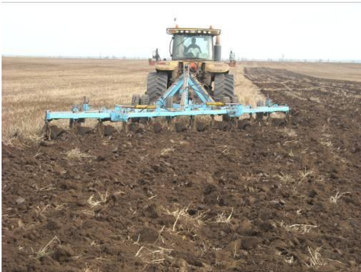
Рисунок 5.1 - Агрегат Challenger MT865В + ПБС-12П на основной обработке почвы
