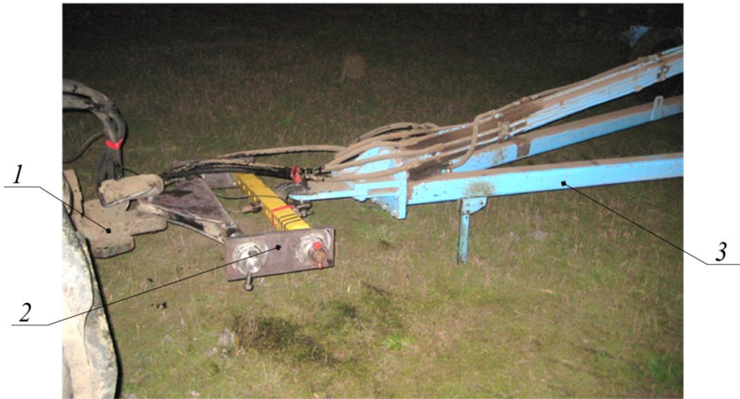
Рисунок 3.10 - Тензометрическое звено в составе МТА: 1 – трактор; 2 – тензометрическое звено; 3 – плуг ПБС-12П
