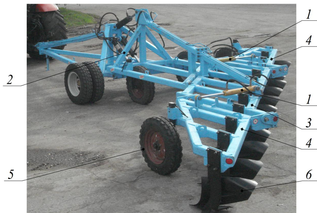
Рисунок 3.4 - Плужная секция прицепного плуга ПБС-12П: 1 – гидроцилиндр перевода плуга в транспортное положение, 2 – навесное устройство, 3 – основная секция, 4 – боковая секция; 5 – опорное колесо с механизмом регулировки глубины обработки, 6 – корпус плуга
