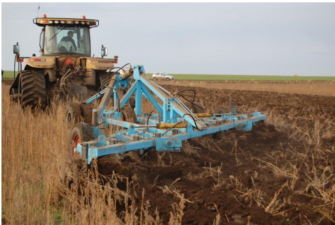
Рисунок 5.7 - Агрегат с трактора Challenger MT865В с плугом ПБС-12П на обработке залежи
