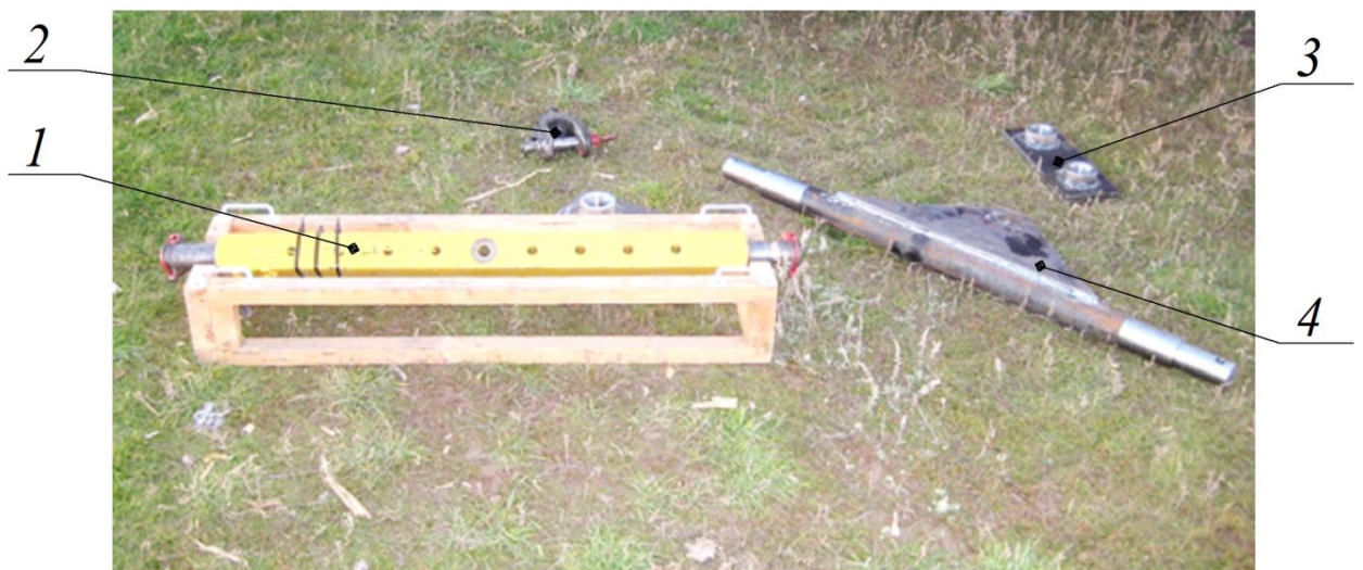
Рисунок 3.9 - Состав тензометрического звена: 1-тензометрическая балка; 2-фаркоп; 3-серьга; 4-промежуточная балка
