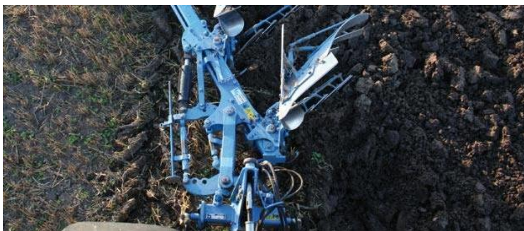
Рисунок 1.10 - Оборотное устройство плугов фирмы Lemken
