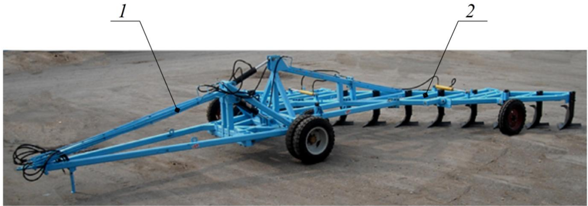
Рисунок 3.1 - Плуг ПБС-12П: 1 – лафет; 2 – плужная секция
