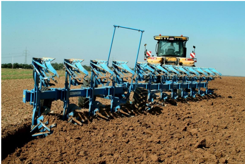
Рисунок 1.14 - Движение агрегата с немецким плугом Lemken Euro Titan 12 в рабочем положении
