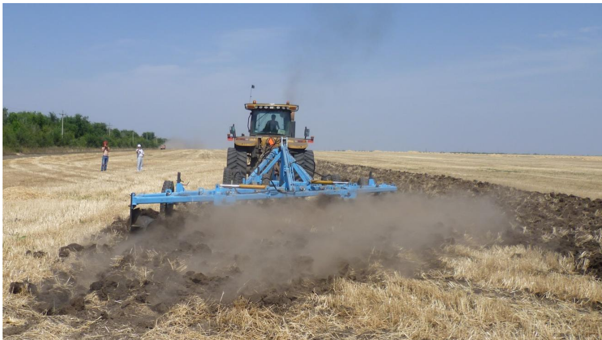
Рисунок 3.7 - Пахотный агрегат состоящий из плуга ПБС-12П с трактором Challenger MT865В на основной обработке почвы
