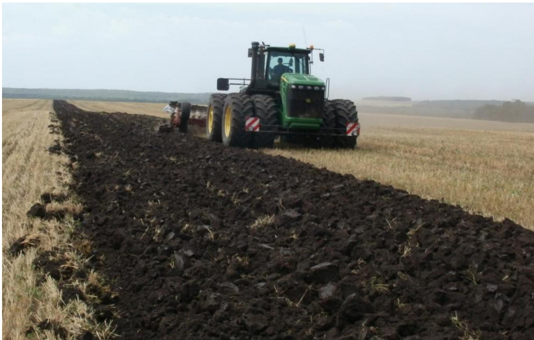
Рисунок 1.18 - Агрегат трактора John Deere 9430 с плугом ПО-10+2П на основной обработке почвы
