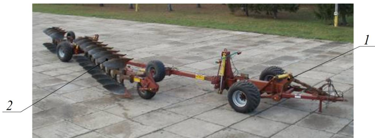
Рисунок 1.17 - Плуг прицепной оборотный ППРО-12-01: 1 – лафет; 2 – плуг
