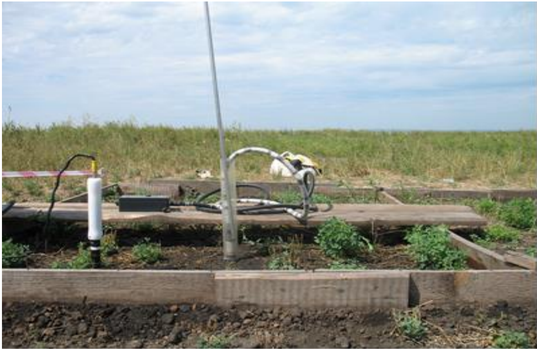
Рисунок 3.9 – Размещение скважин для измерения влажности почвы приборами Delta-T PR-2 и TRIME-FM
