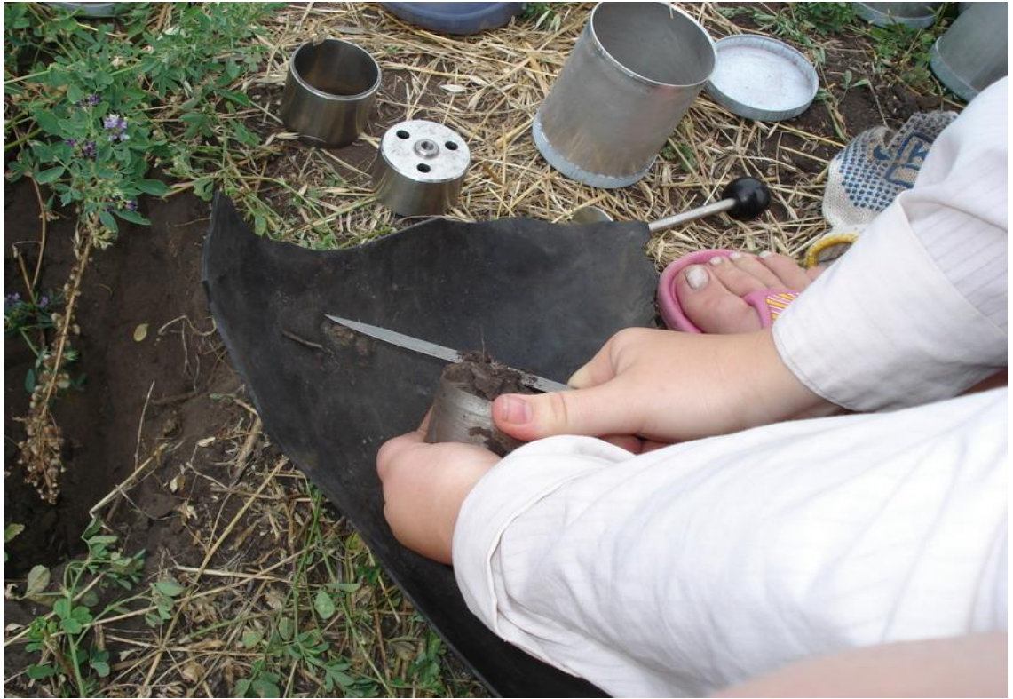
Рисунок 3.6 – Определение плотности сложения почвы методом режущего кольца
