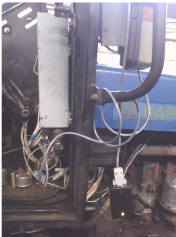
Рисунок 4.9 – Электронный блок управления с модулем «Блютуз» и переключателями режимов работы
