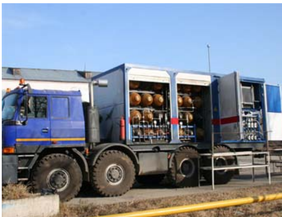
Рисунок 1.3 – Активный передвижной автогазозаправщик мод. 1200К (с дожимным компрессором)
