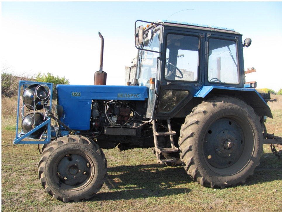
Рисунок 4.14 – Общий вид трактора МТЗ-82.1, оснащённого системой распределённой подачи газообразного топлива по эжекционному принципу
