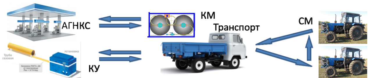
Рисунок 5.6 – Схема заправки сельскохозяйственной техники компримированным природным газом на основе съёмных кассетных модулей
