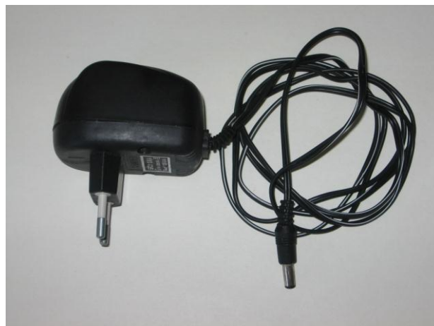
Рис.8. Зарядное устройство для Акватора – 02
