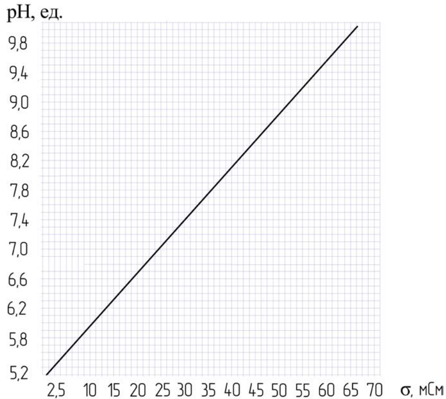
Рисунок 18 – Теоретическая зависимость проводимости среды от рН биоотходов
