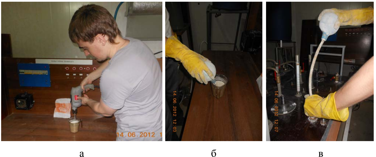
Рисунок 31 – Фото-журнал контроля рН: а – измельчение раствора извести; б – забор известковой смеси; в – добавление известкой смеси в закисленный реактор через шлюзовую арматуру
