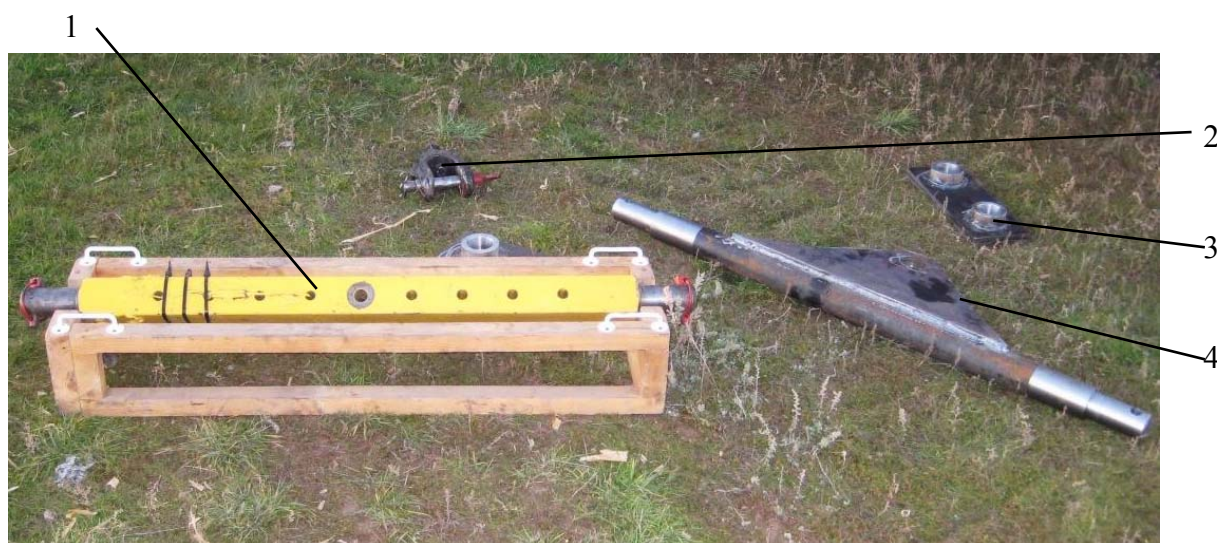
Рис. 1. Состав тензометрического звена: 1-тензометрическая балка; 2-фаркоп; 3-серьга; 4-промежуточная балка
