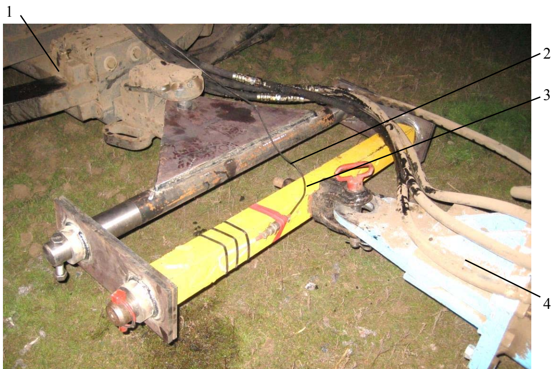
Рис. 4. Тензовено в сборе: 1–трактор; 2–сигнальный кабель; 3–тензовено; 4– прицепной плуг
